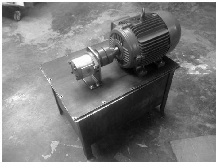
**Figura 5.4. Acoplamiento motor – bomba**
