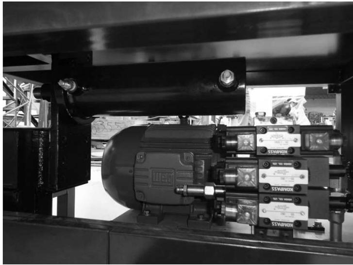
**Figura 3.17. Montaje del cilindro hidráulico principal**
