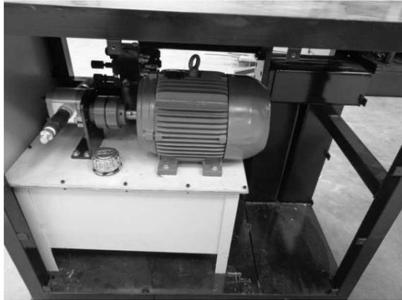
**Figura 5.15. Montaje sistema hidráulico a la estructura base**
