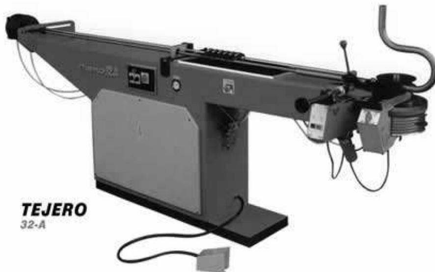
**Figura 2.2. Dobladora de tubos electromecánica**
