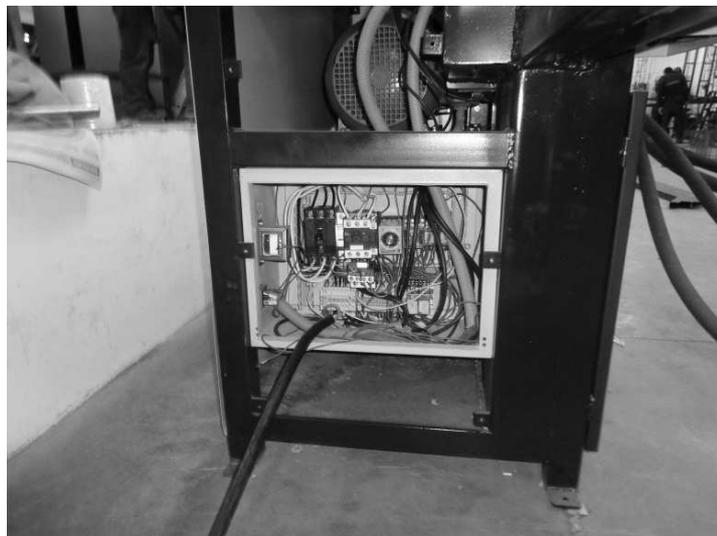
**Figura 3.18. Colocación del tablero eléctrico de control**
