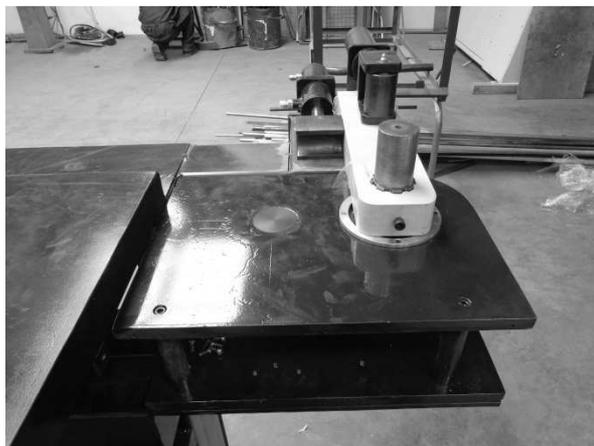
**Figura 5.16. Montaje del mecanismo y cilindros hidráulicos secundarios**
