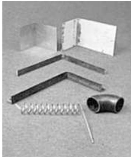
**Figura 1.1. Productos semi-manufacturados obtenidos por doblado**
