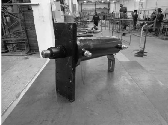
**Figuras 5.11. Cilindros Hidráulicos**
