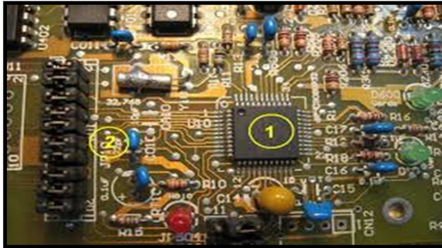
Figura 2.8 Elementos de soporte de un Micro controlador.
