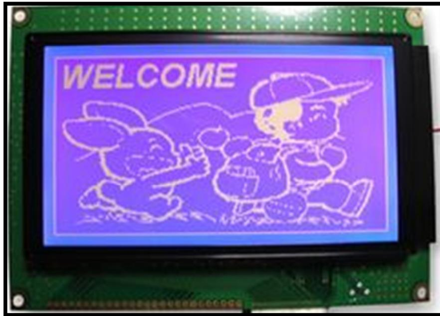
**Figura 2.1. Pantalla LCD 128x240.**
