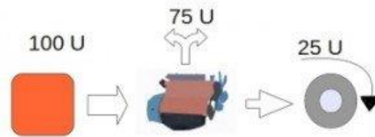
Figura 1.6 Eficiencia energética de motor de combustión interna a gasolina.
