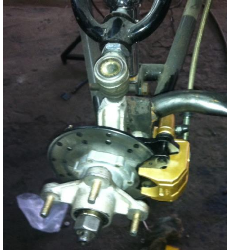
Figura 3.86 Acople: Tijera-Punta de eje-Disco de freno-Manzana-Mordaza de freno.
