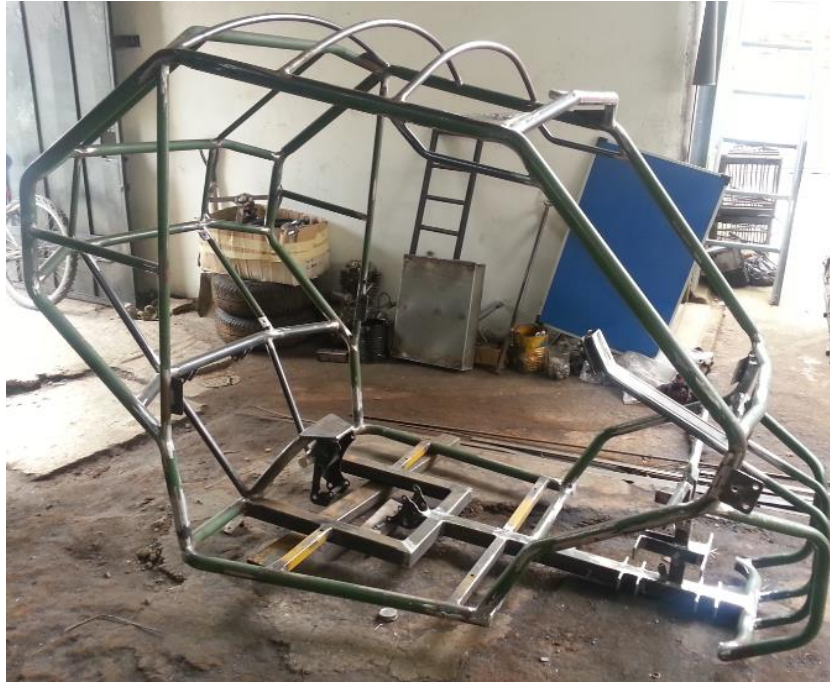
Figura 4.5 Armado y soldado estructura principal.
