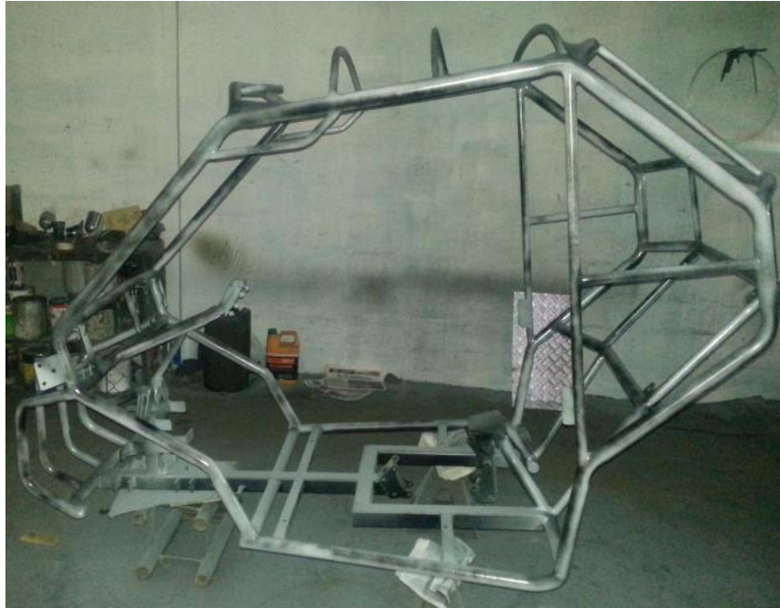
Figura 4.7 Pintura estructura Jaula de seguridad y perfil principal.
