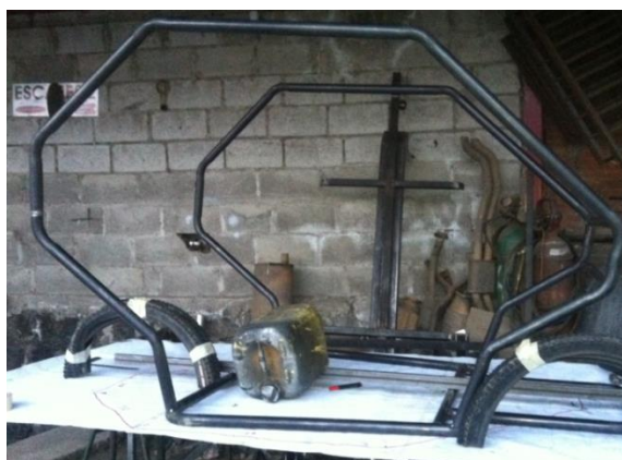
Figura 4.2 Armado de tubo perfil lateral y base.
