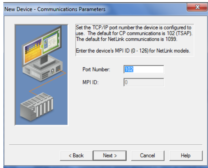
Figura 60. Configuración del número de puerto para comunicaciones
