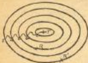
T — Carga electrica agitada e ether na estação transmissora. R, R' — estações receptoras irradiadas pelas ondas a-b, b-c, c-d, d-e — comprimentos de onda.
