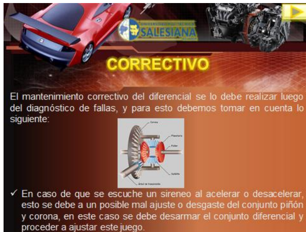
Figura 3. 88 Mantenimiento Correctivo del Diferencial.
