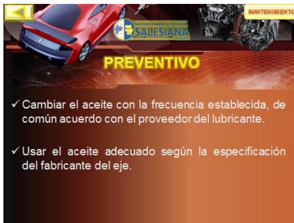
Figura 3. 89 Mantenimiento Preventivo del Diferencial.
