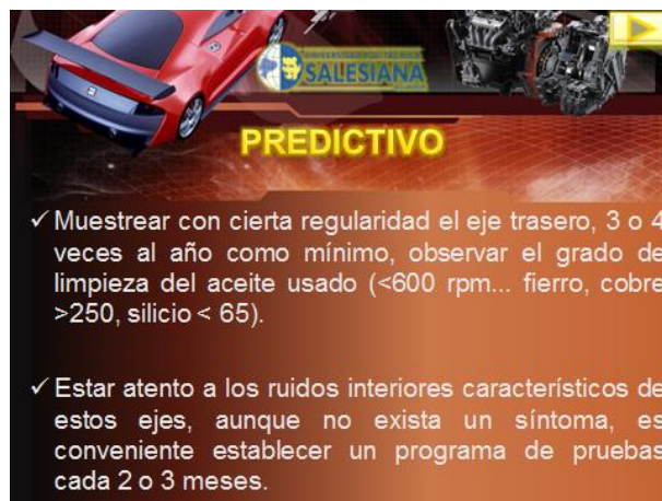
Figura 3. 87 Mantenimiento Predictivo del Diferencial.
