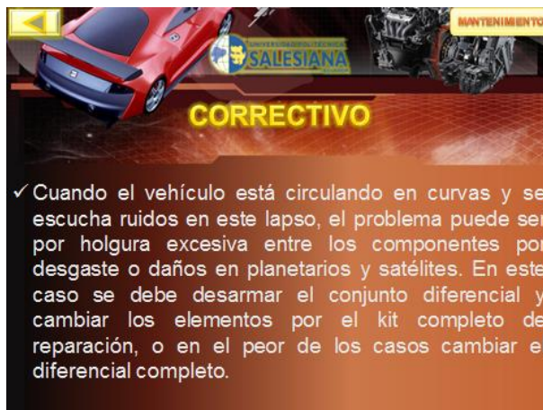
Figura 3. 91 Mantenimiento Correctivo del Diferencial.
