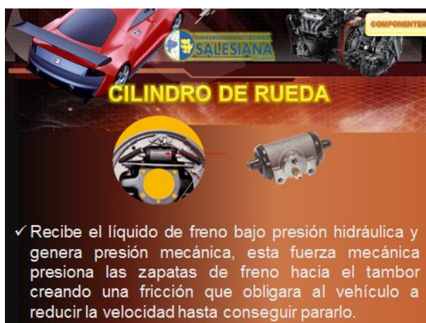
Figura 3. 45 Cilindro de Rueda.
