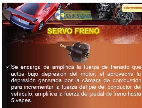
Figura 3. 42 Servo Freno.
