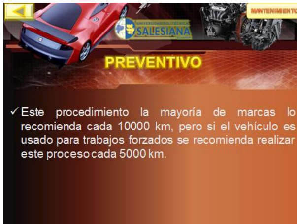
Figura 3. 60 Mantenimiento Preventivo del Sistema de Frenos.
