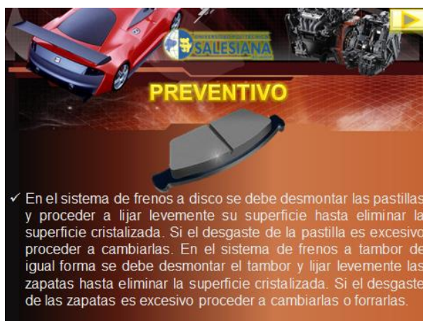
Figura 3. 57 Mantenimiento Preventivo del Sistema de Frenos.
