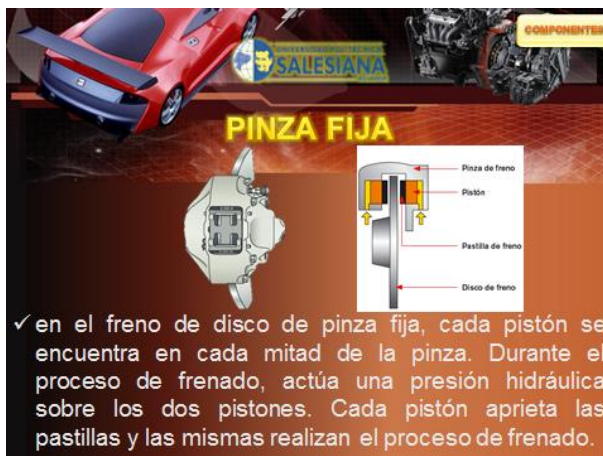
Figura 3. 47 Pinza Fija.
