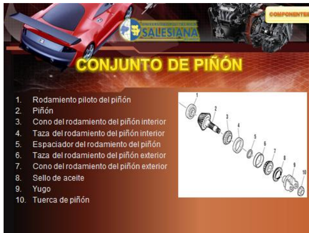
Figura 3. 77 Conjunto Piñón del Diferencial.
