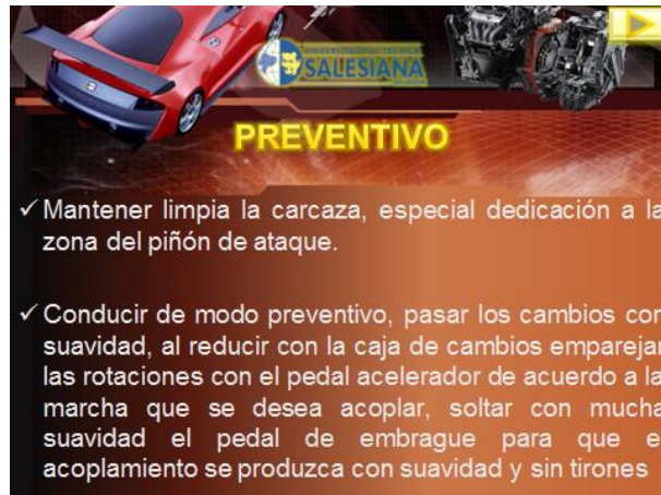
Figura 3. 86 Mantenimiento Preventivo del Diferencial.
