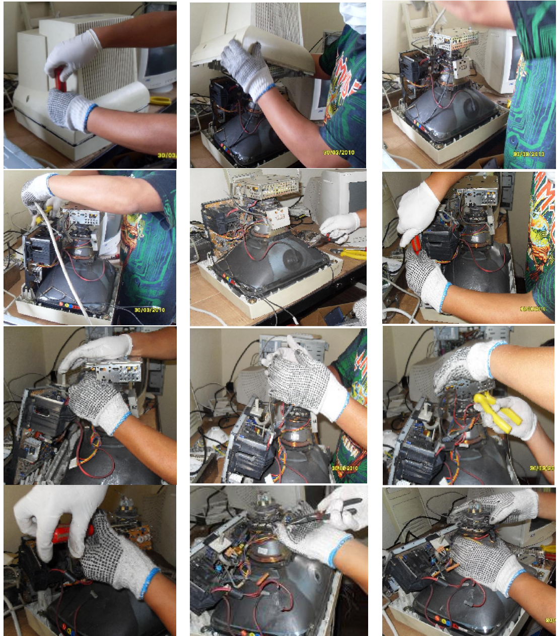
Grafico 7.10. Desmantelamiento total de un monitor CRT
