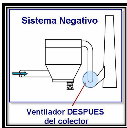
FIGURA 3.11. Sistema de presión negativa 21
