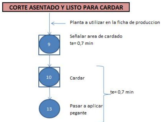
Ilustración 30 Diagrama de cardar par de cortes Fuente: Elaboración propia
