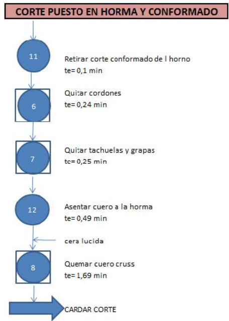
Ilustración 29 Diagrama de asentado de cortes Fuente: Elaboración propia
