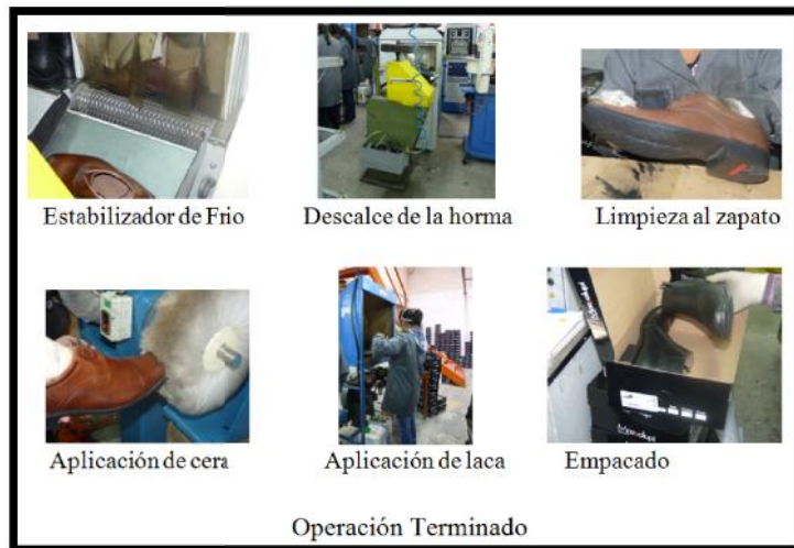
Ilustración 21 Sub-proceso montaje (terminado) Fuente: Elaboración propia
