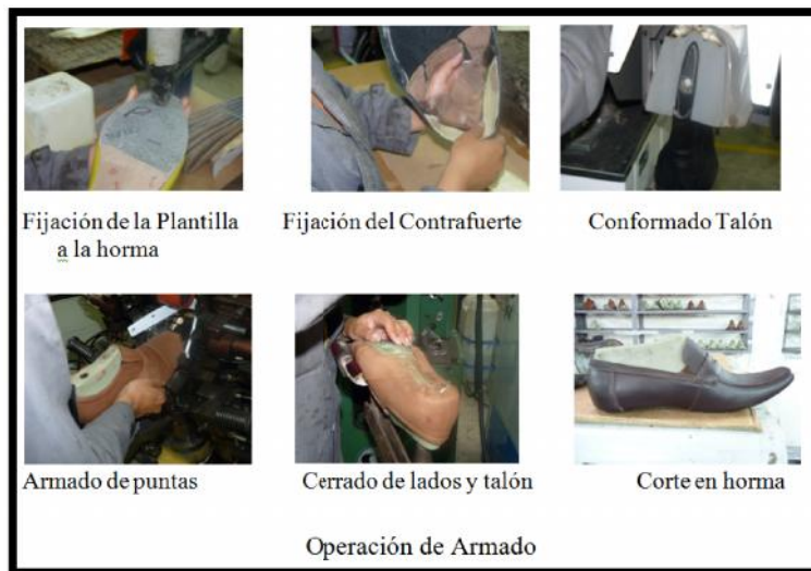
Ilustración 19 Sub-proceso montaje (armado) Fuente: Elaboración propia
