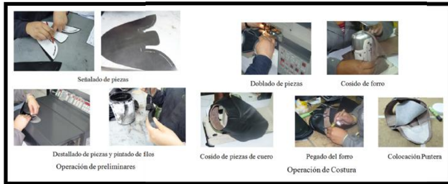
Ilustración 18 Sub-proceso armado Fuente: Elaboración propia
