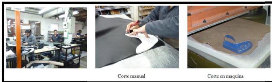
Ilustración 17 Sub-proceso corte Fuente: Elaboración propia
