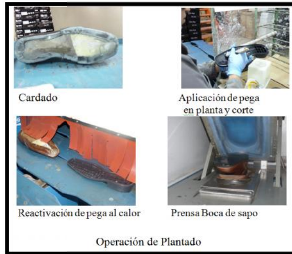
Ilustración 20 Sub-proceso montaje (plantado) Fuente: Elaboración propia
