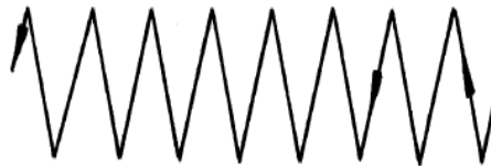
Fig.27 Movimiento en zig-zag del cordón 50
