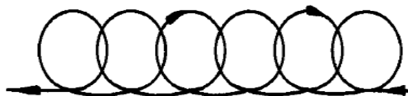
Fig.25 Movimiento circular del cordón 48
