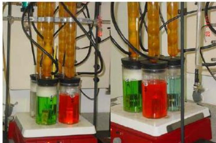
**Figura 2.11** Inicio de la prueba de corrosión
