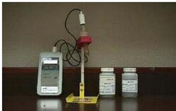
**Figura 2.7** Medidor del pH digital
