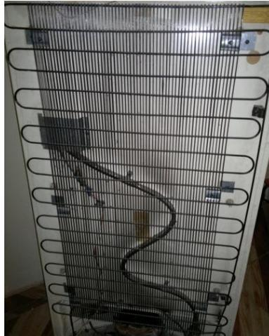
Figura 1.8 Condensador
