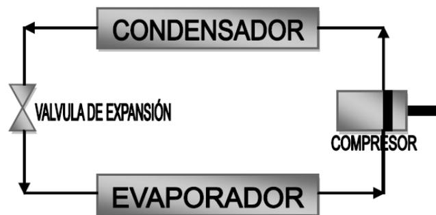
**Figura. 1.1** Sistema de Refrigeración convencional.
