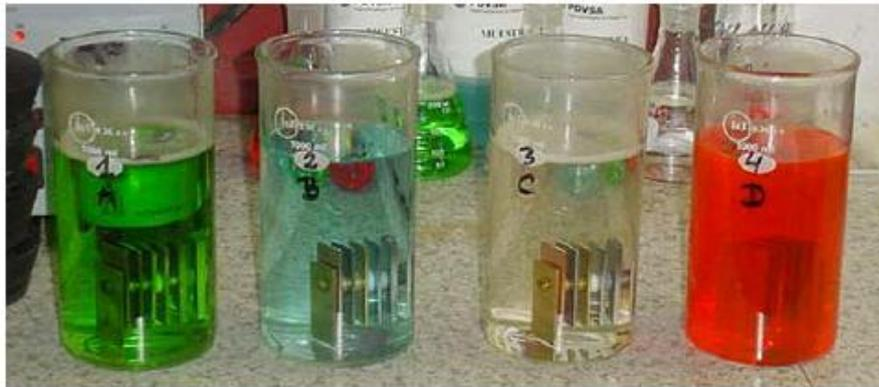
**Figura 2.10** Muestra de los cupones de corrosión
