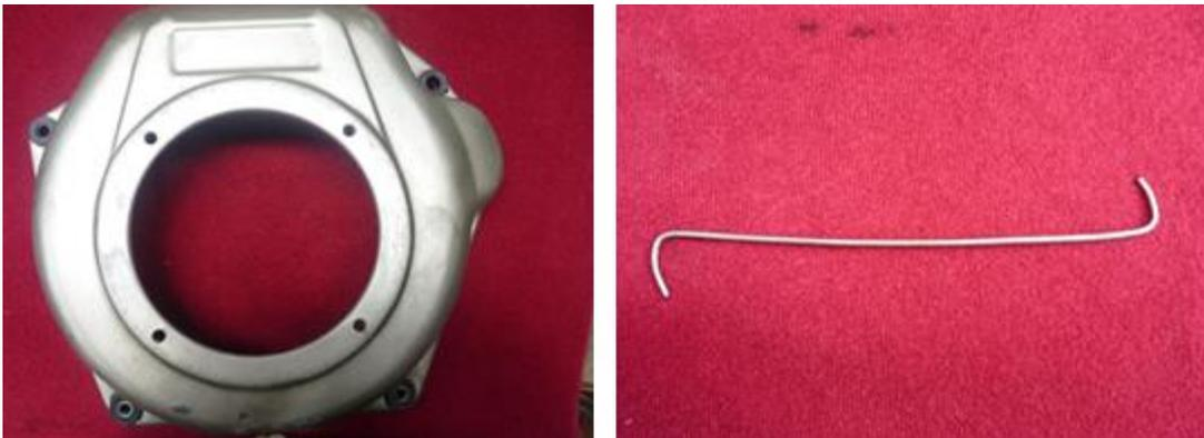
*Figura 3. 31 Protección del volante motor y varillita del descompresor.
