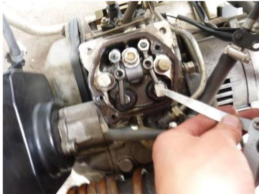
*Figura 3. 56 Calibración de válvulas.
