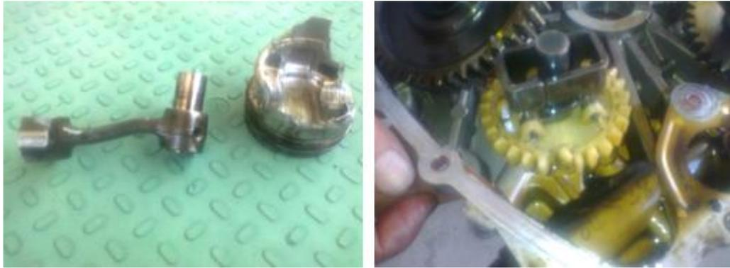
*Figura 3. 9 Elementos dañados en el motor.
