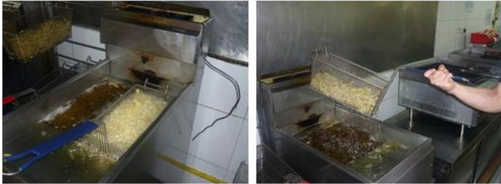
**Figura 3. 2 Maquina de frituras (Freidora).**
