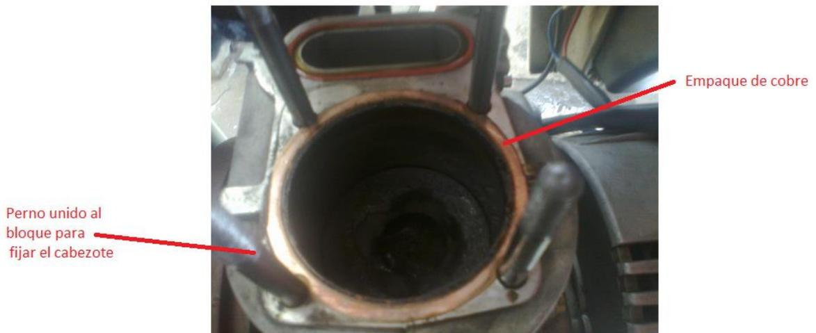
**Figura 3. 35 Empaque de cobre.**
