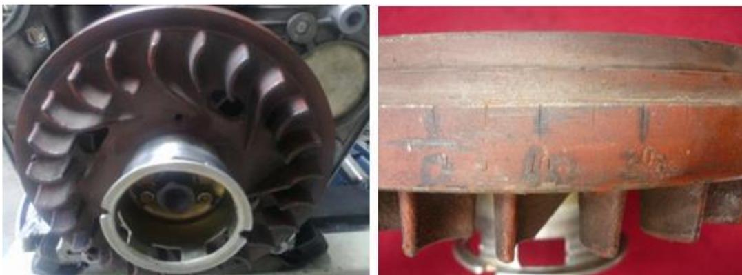
**Figura 3. 37 Volante de inercia.**
