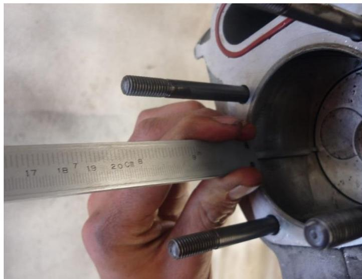
**Figura 2. 12 Mediciones en el cilindro.**
