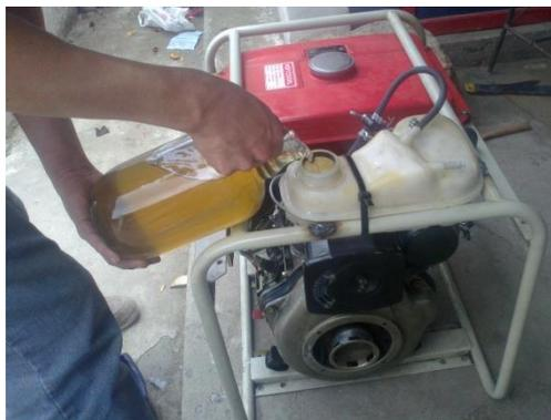
*Figura 3. 20 Colocación de aceite residual en un depósito diseñado para tal fin.
