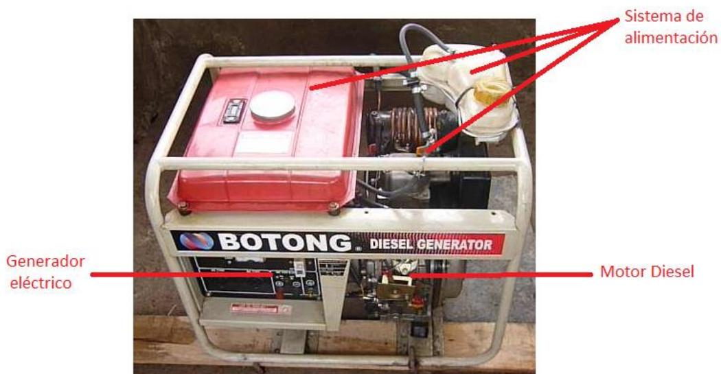
*Figura 3. 26 Partes del generador HDY-2500L.
