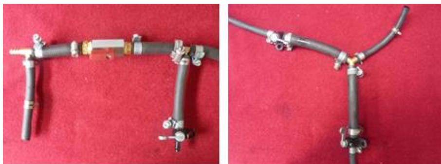
*Figura 3. 28 Cañerías del sistema de alimentación.
