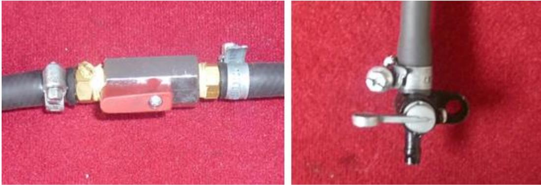
*Figura 3. 14 Acoples para el funcionamiento en paralelo del aceite residual de frituras en el generador.
