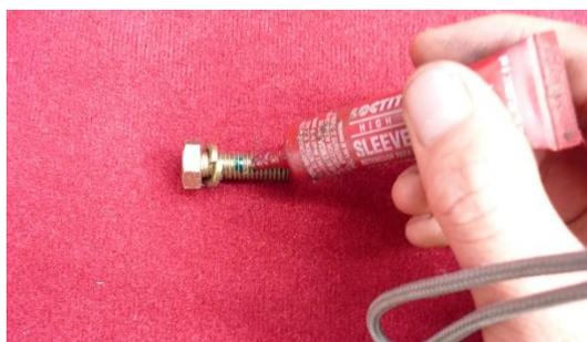
**Figura 3. 50 Colocación de LOCTITE.**
