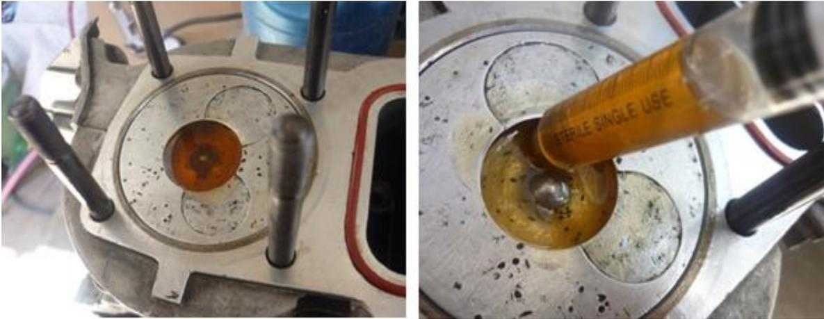
**Figura 2. 15 Extracción del aceite de la cámara de combustión.**
