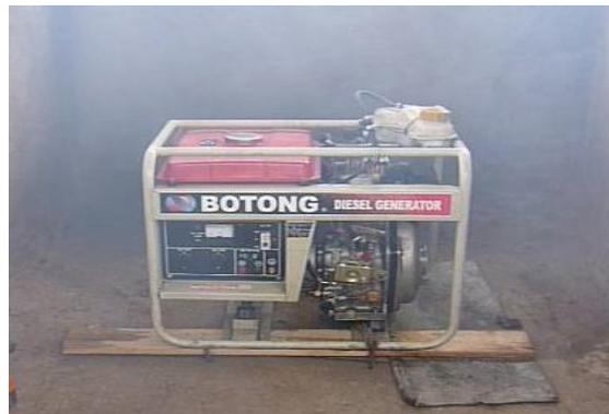
**Figura 3. 22 Arranque con aceite de 2 tiempos, generación de humo contaminante.**
