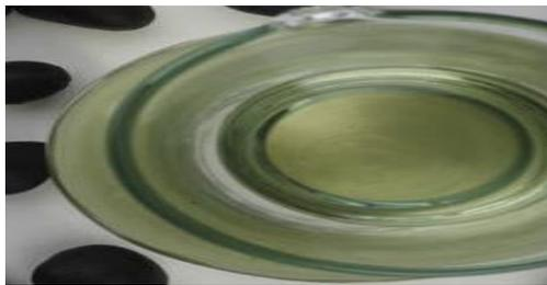
*Figura 1. 19 Aceite filtrado luego del proceso de blanqueado.
