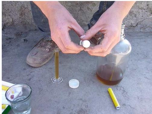
*Figura 3. 18 Comprobador del nivel de agua existente en el aceite residual.
