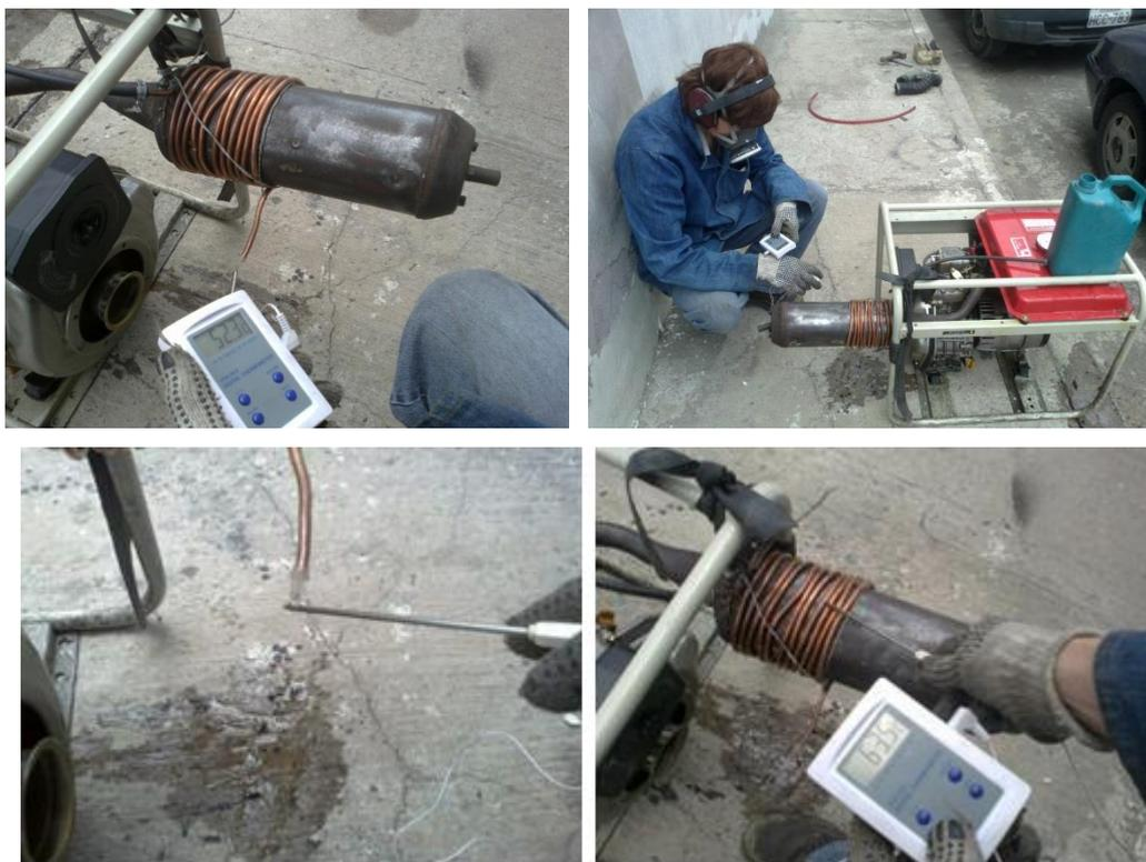
**Figura 3. 11 Adaptación de un escape para la colocación de un serpentín.**
