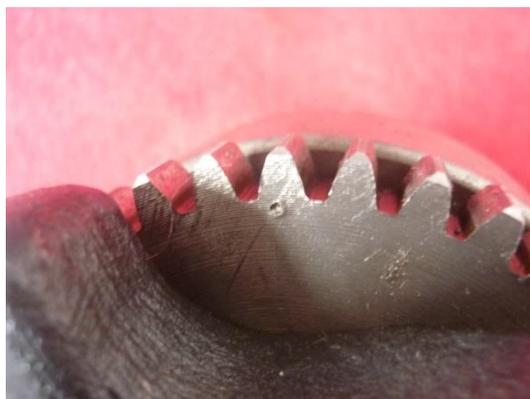
**Figura 3. 52** Marcas del compensador de masa con respecto al cigüeñal.
