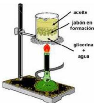
**Figura 1. 18 El aceite neutralizado se ubica en la parte superior**
