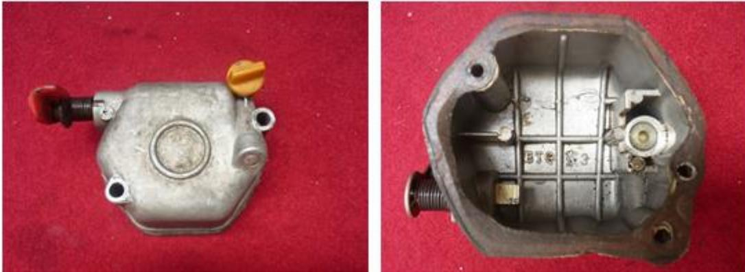
*Figura 3. 32 Tapa de válvulas.*
