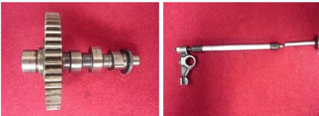
**Figura 3. 43 Árbol de levas, varillas empujadoras y taqués.**
