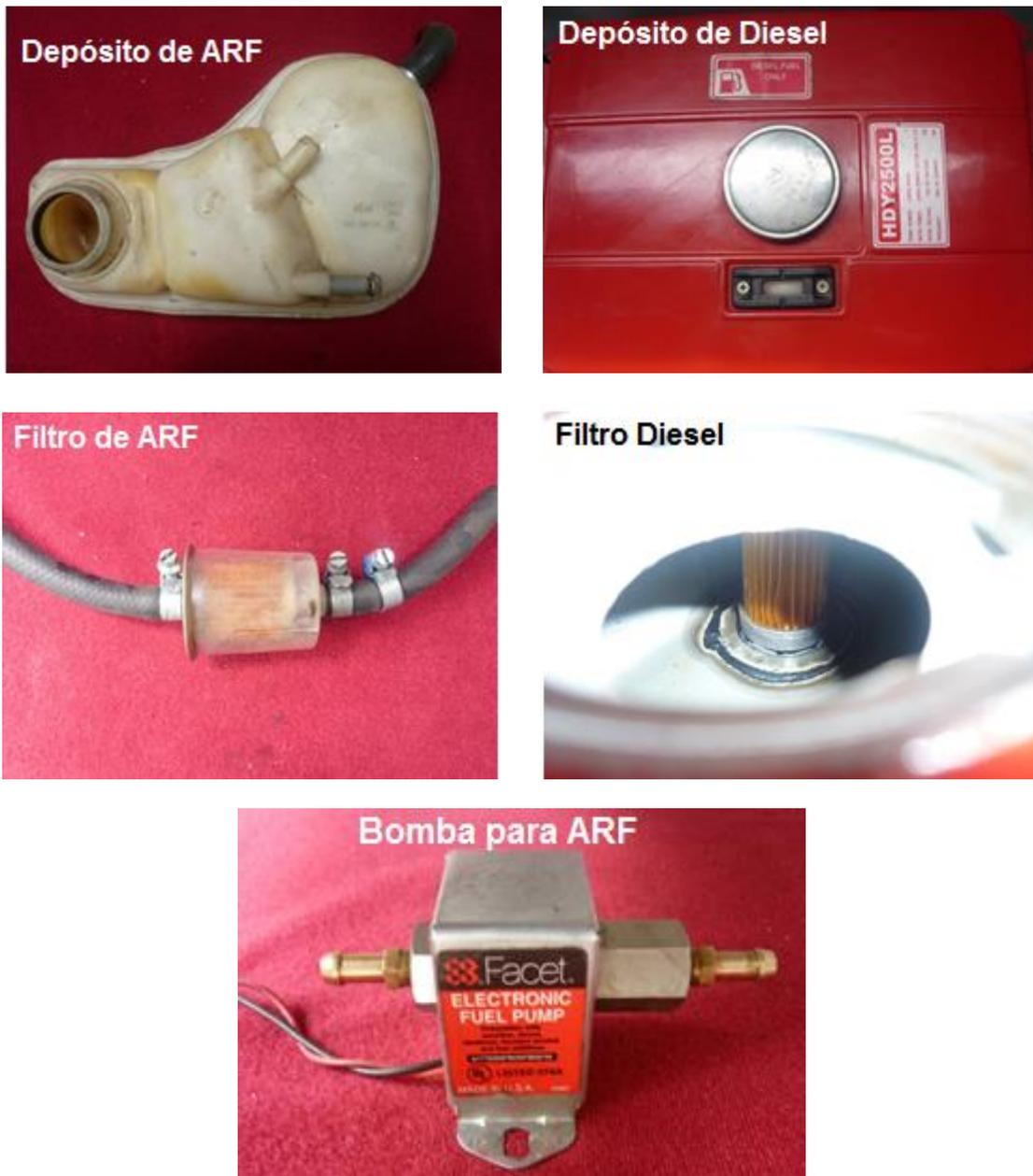
**Figura 3. 29 Componentes del sistema de alimentación.**
