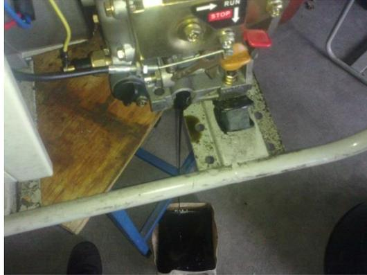
**Figura 3. 38 Extracción del aceite motor.**
