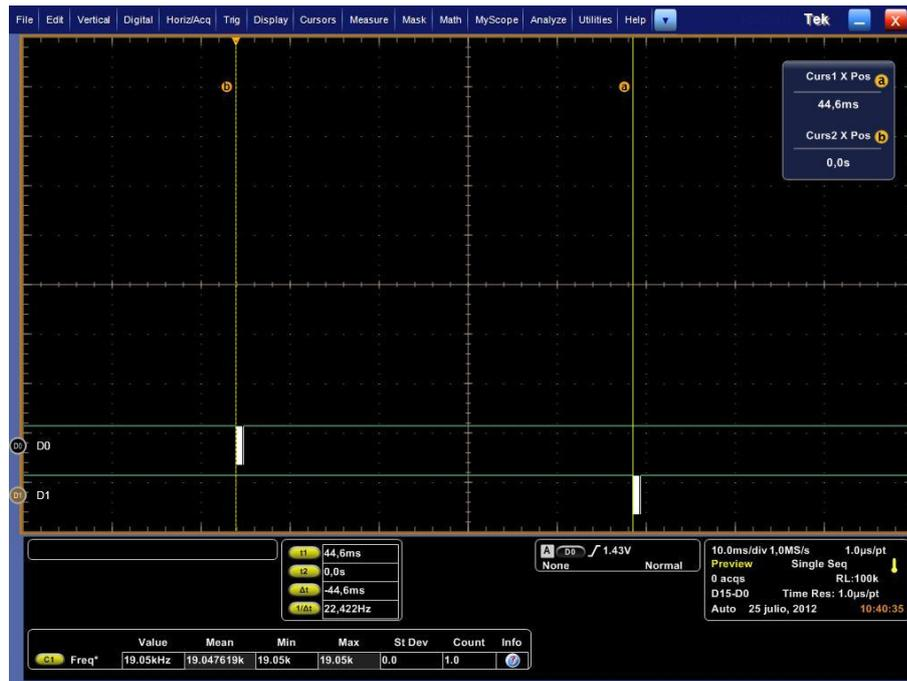
**Figura 4.3:** Transmisión de datos desde el módulo Bluetooth Local al Remoto a 19,05kHz.
