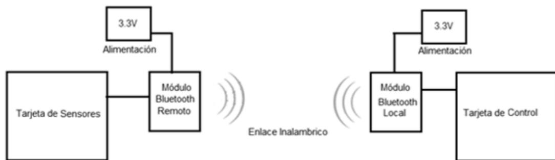
**Figura 1:** Diagrama de bloques de la transmisión de datos vía Bluetooth
