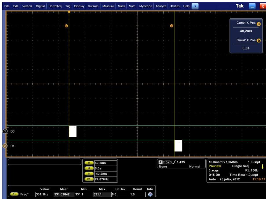
**Figura 4.4:** Transmisión de datos desde el módulo Bluetooth Local al Remoto a 331,1Hz.
