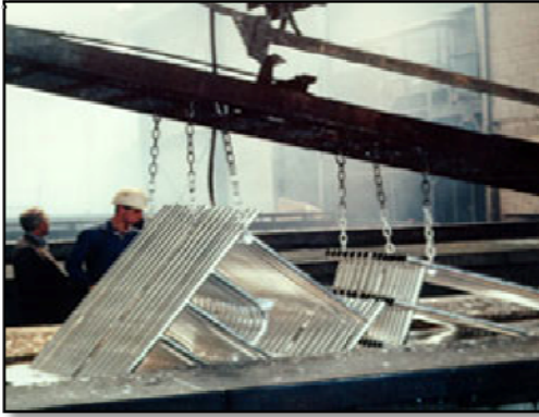
Fig. N° 2.21-3:Cuva de galvanizado.
