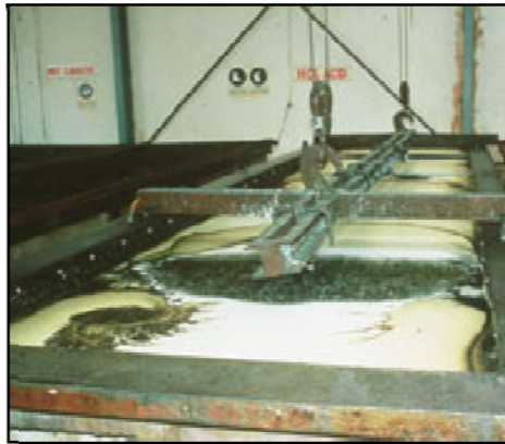
Fig. N° 2.21-2:El tanque de decapado.
