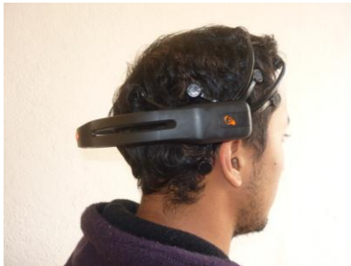
Figura 2 Colocación de la EPOC
