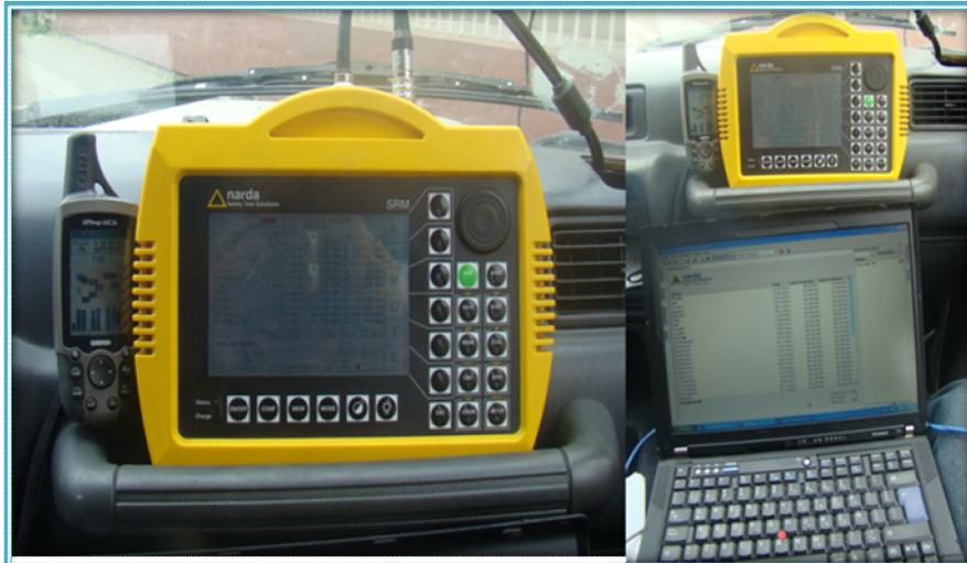
**Figura 59. Narda SRM – 3000 montado en vehículo con GPS y laptop para control remoto**
