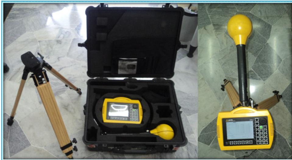
Figura 46. Medidor de Radiación Selectivo (SRM – 3000)
