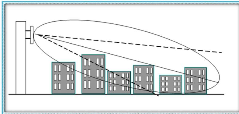
Figura 40. Inclinación del Haz mediante desfases en la Alimentación (Down-tilt Eléctrico)
