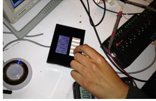
Figura 2.16: Activación del panel multifunción, para probar el bus
