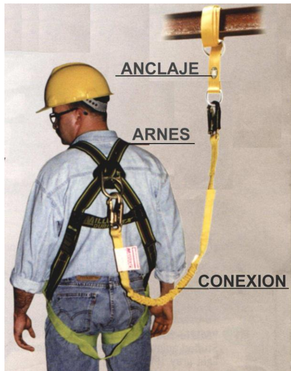
Figura 16. Protección contra caídas.
