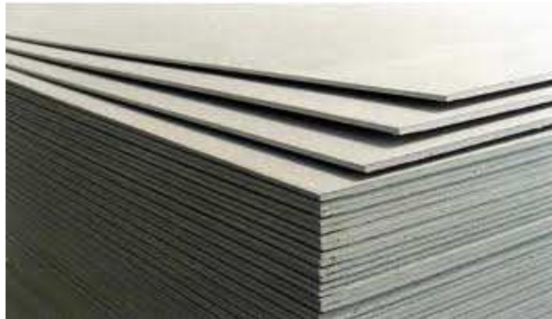
Imagen No. 3. Planchas de Yesos
