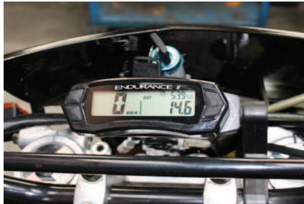
Figura 3.8. Interruptor principal y velocímetro
