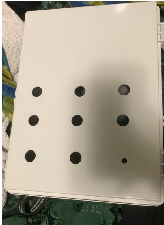
Figura 112. Perforación para botoneras de control. Fuente: Elaborado por autores.
