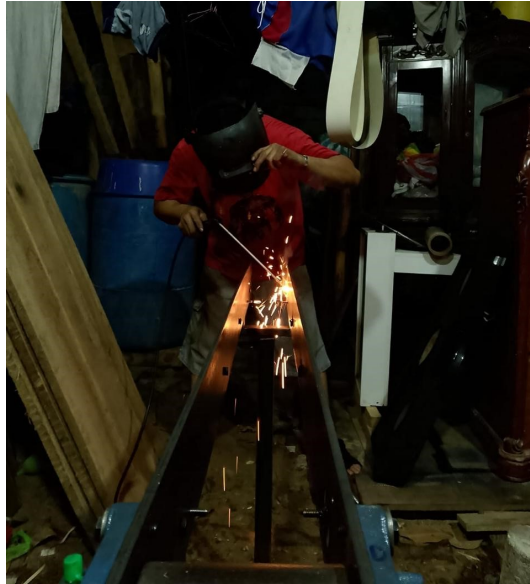
Figura 104. Soldadura de templadores de rodillo. Fuente: Elaborado por autores.
