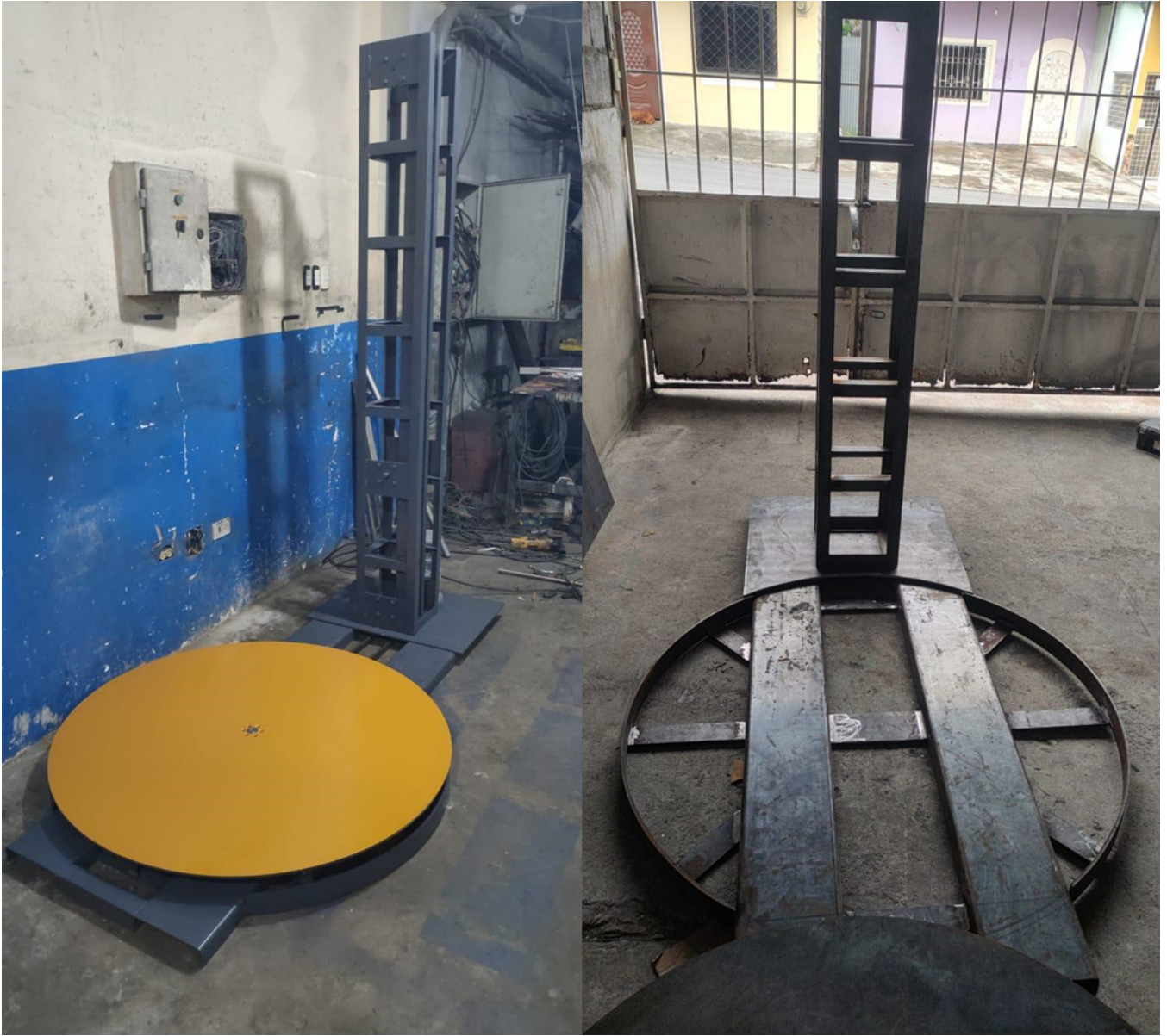
Figura 100: Estructura base giratoria y torre porta film ensamblada.
