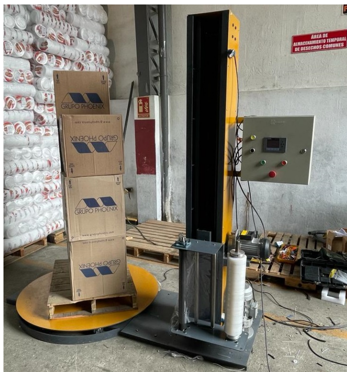
Figura 62: Prueba de funcionamiento con carga. Fuente: Autoría Propia.
