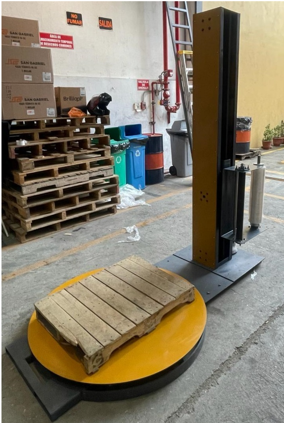
Figura 61: Prueba de funcionamiento sin carga. Fuente: Autoría Propia.
