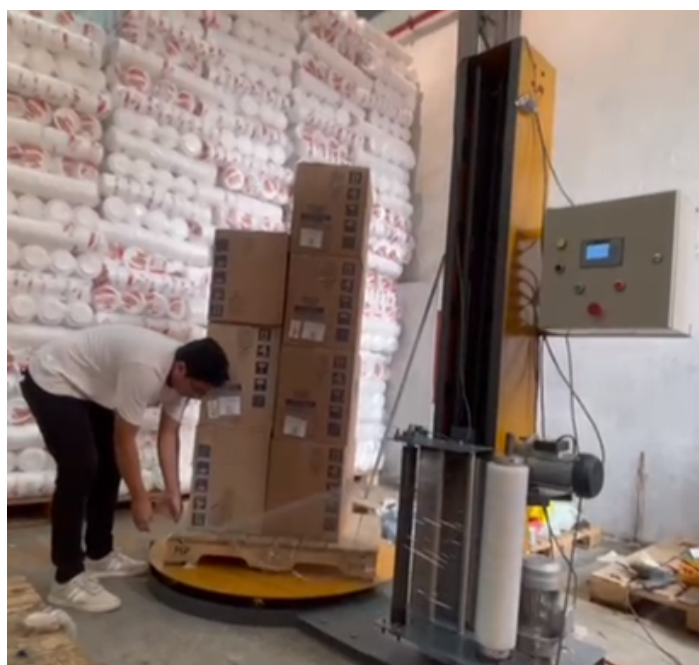
Figura 63: Colocación del rollo film en la base de las cajas. Fuente: Autoría Propia.
