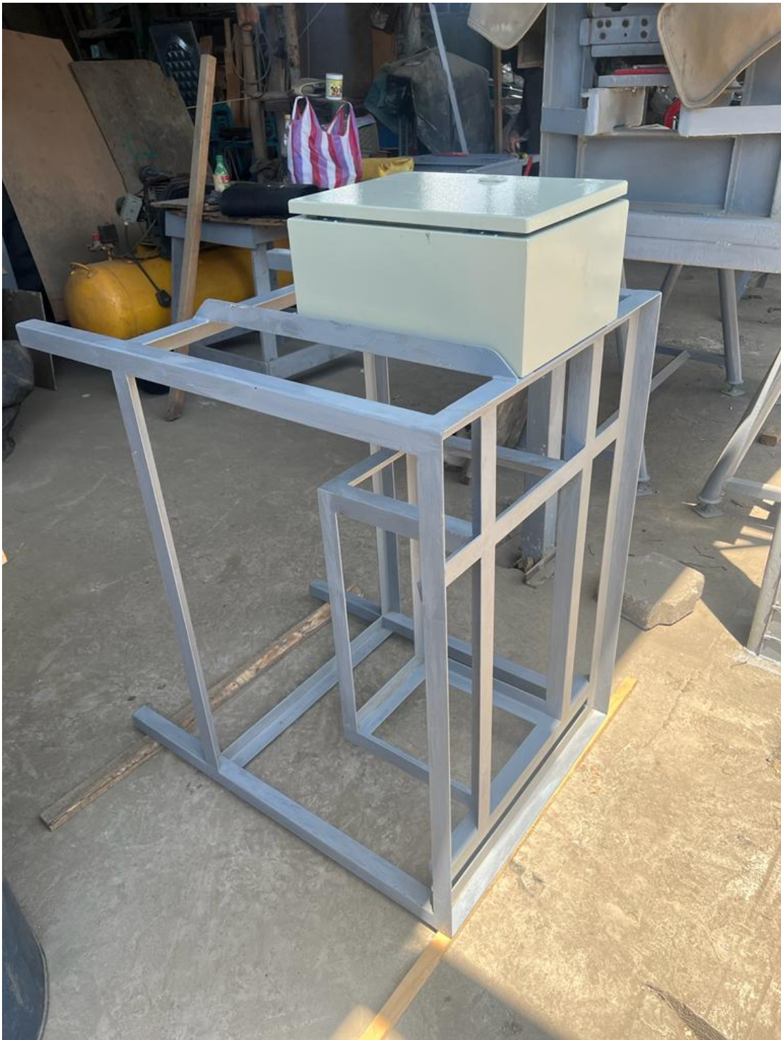
Figura 101. Caja de distribución acoplado al soporte mecánico, por A. Valarezo y R. Izquierdo.
