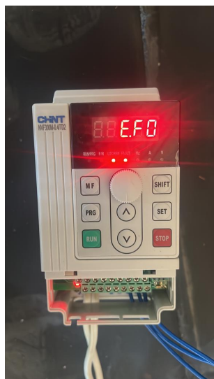
Figura 88. Error de prueba en el variador de frecuencia por tiempo de aceleración corto, por A. Valarezo y R. Izquierdo.
