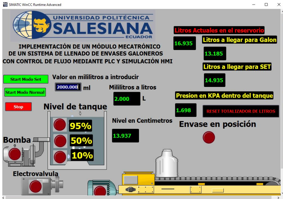
Figura 84. Introducción de parámetros en el modo set, por A. Valarezo y R. Izquierdo.
