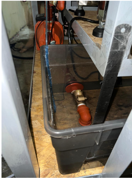
Figura 77. Colocación de regla dentro del reservorio para la medición del nivel en centímetros, por A. Valarezo y R. Izquierdo.
