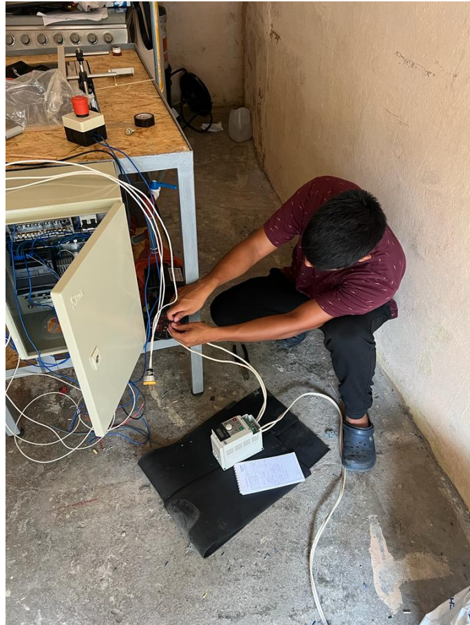
Figura 71. Conexión de variador de frecuencia 220v a la bomba trifásica para pruebas independientes, por A. Valarezo y R. Izquierdo.
