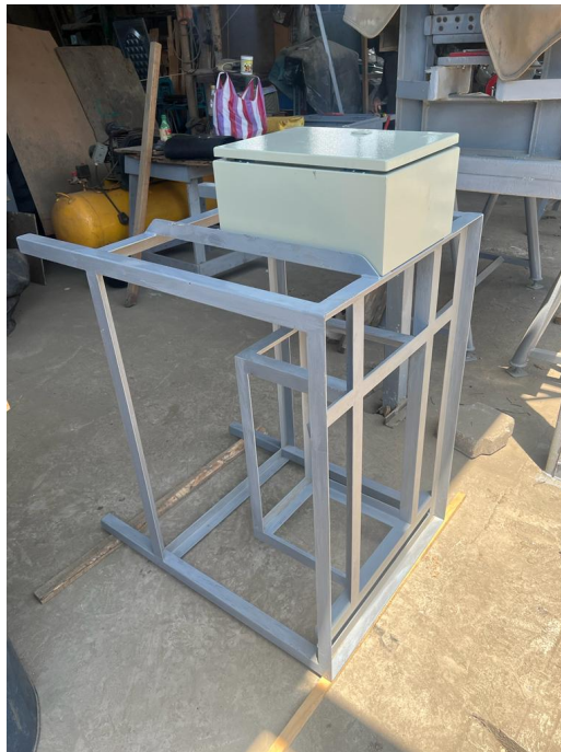
Figura 75. Soporte de la estructura metálica acoplada a la caja de distribución.
