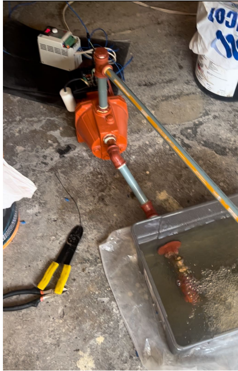
Figura 90. Prueba Piloto del variador de frecuencia junto al motor trifásico, por A. Valarezo y R. Izquierdo.
