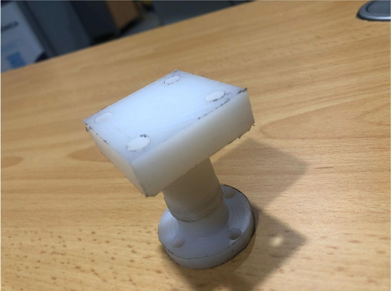
Figura 45. Base del robot KUKA mecanizada, por D. Córdova.
