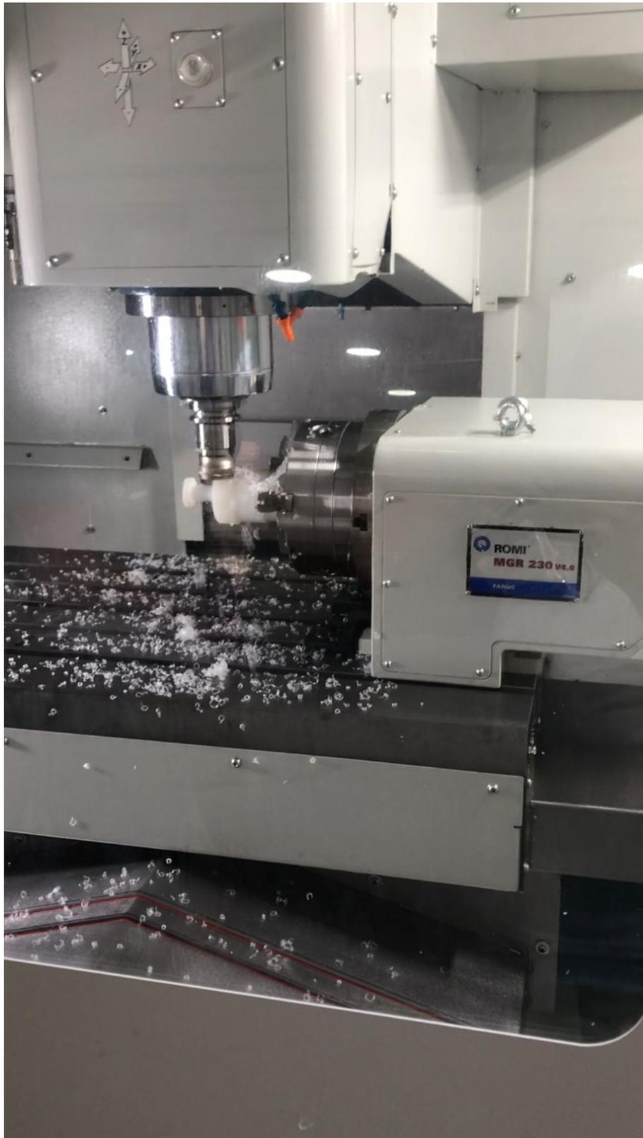
Figura 43. Proceso de planeado en centro de mecanizado CNC, por D. Córdoba.
