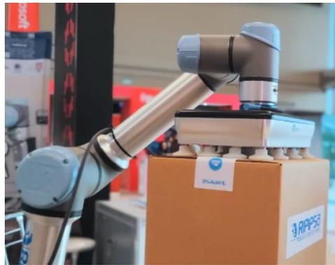
Figura 18. Gripper de vacío modelo VGP20 [20].
