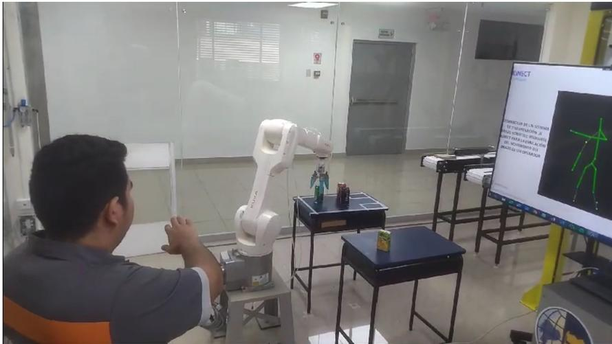
Figura 30. Operador posicionando el gripper para la toma del objeto, por D. Córdova.
