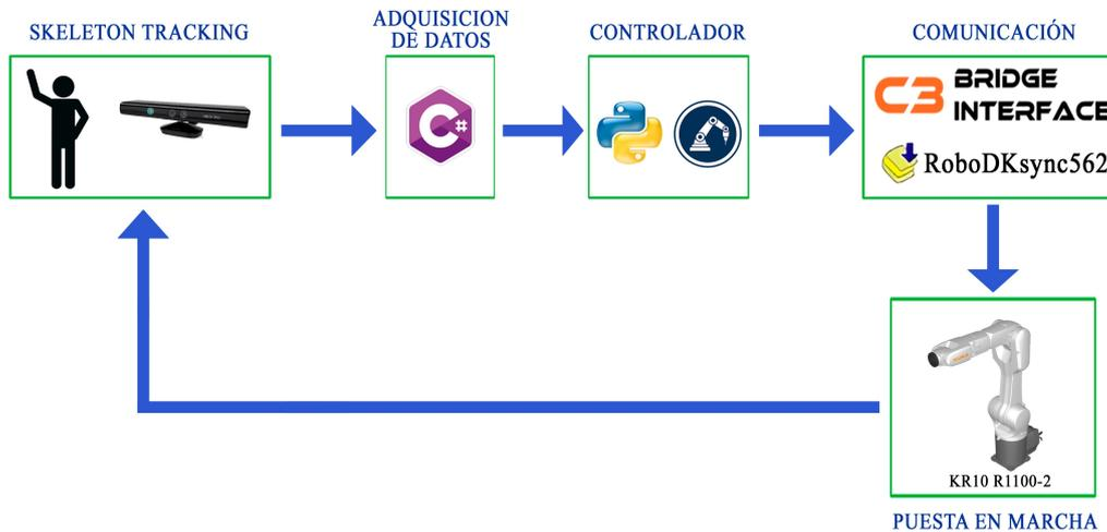
Figura 26. Diagrama de flujo del sistema de teleoperación, por D. Córdova.
