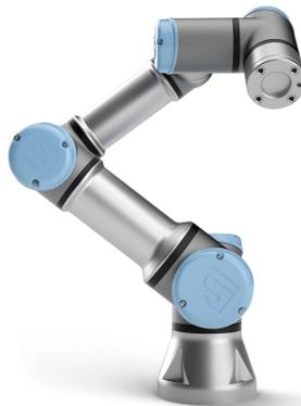
Figura 10. Robot colaborativo 6 GL [14].
