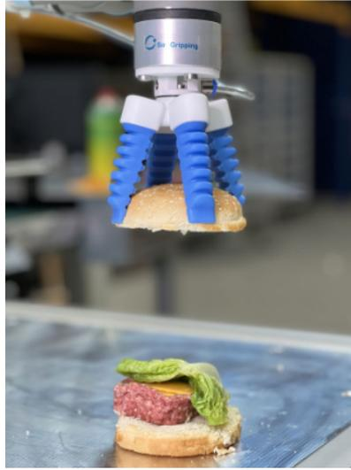
Figura 17. SoftGripper orientado a la manipulación de geometrías irregulares [20].
