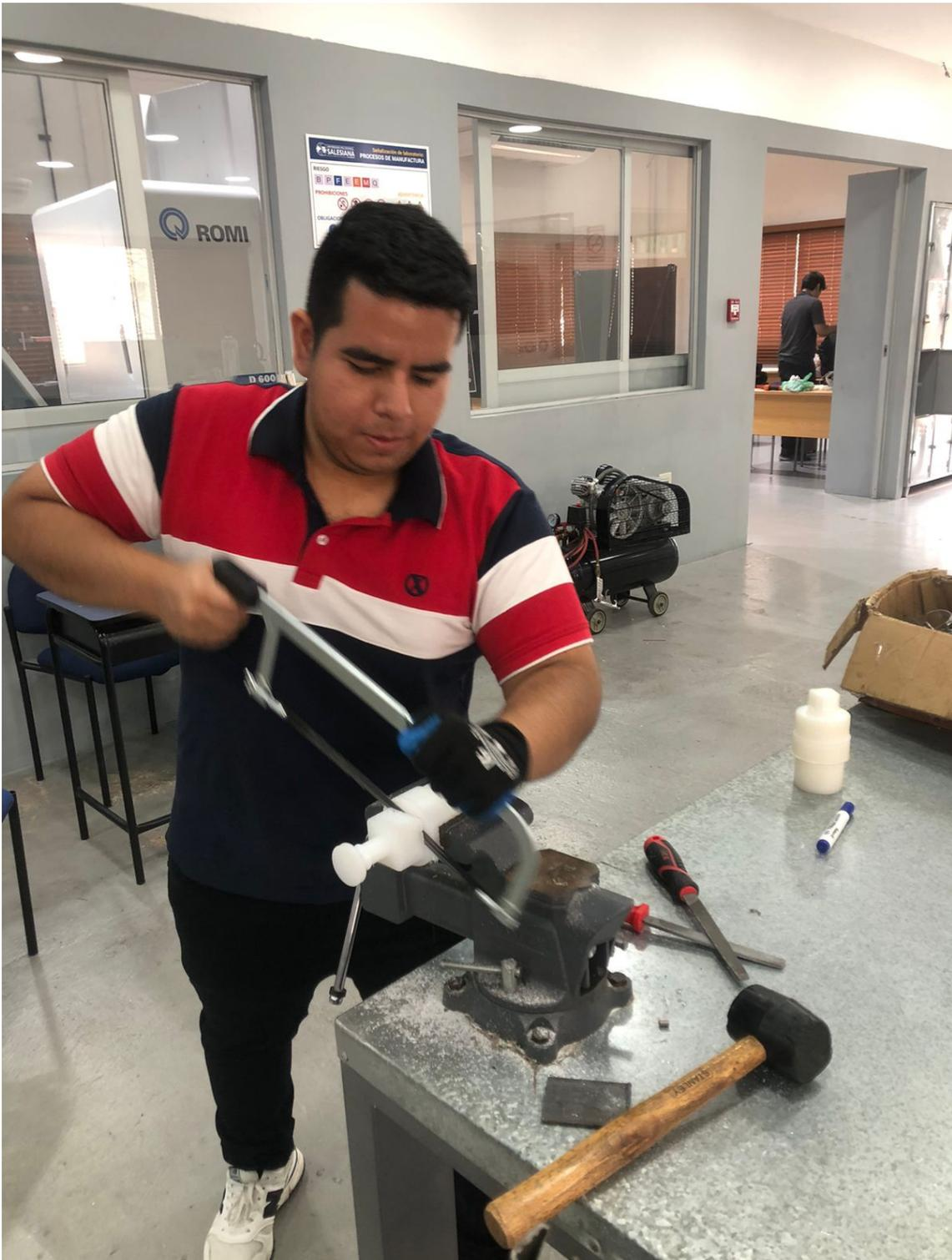
Figura 44. Corte del exceso de nylon, por D. Córdova.
