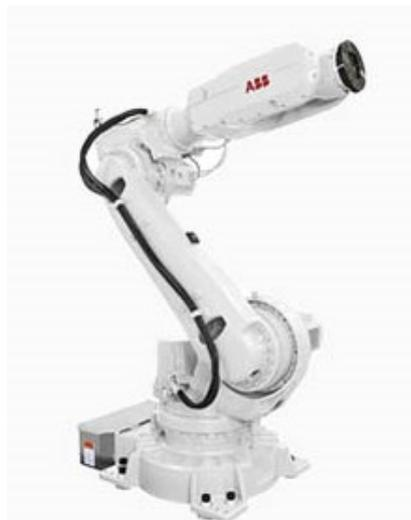
Figura 4. Brazo robot articulado 6 GL [10].
