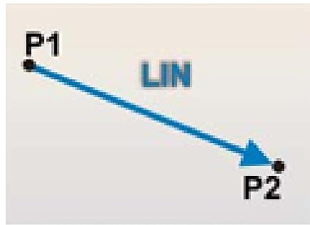
Figura 12. Trayectoria del robot con el comando LIN [9].
