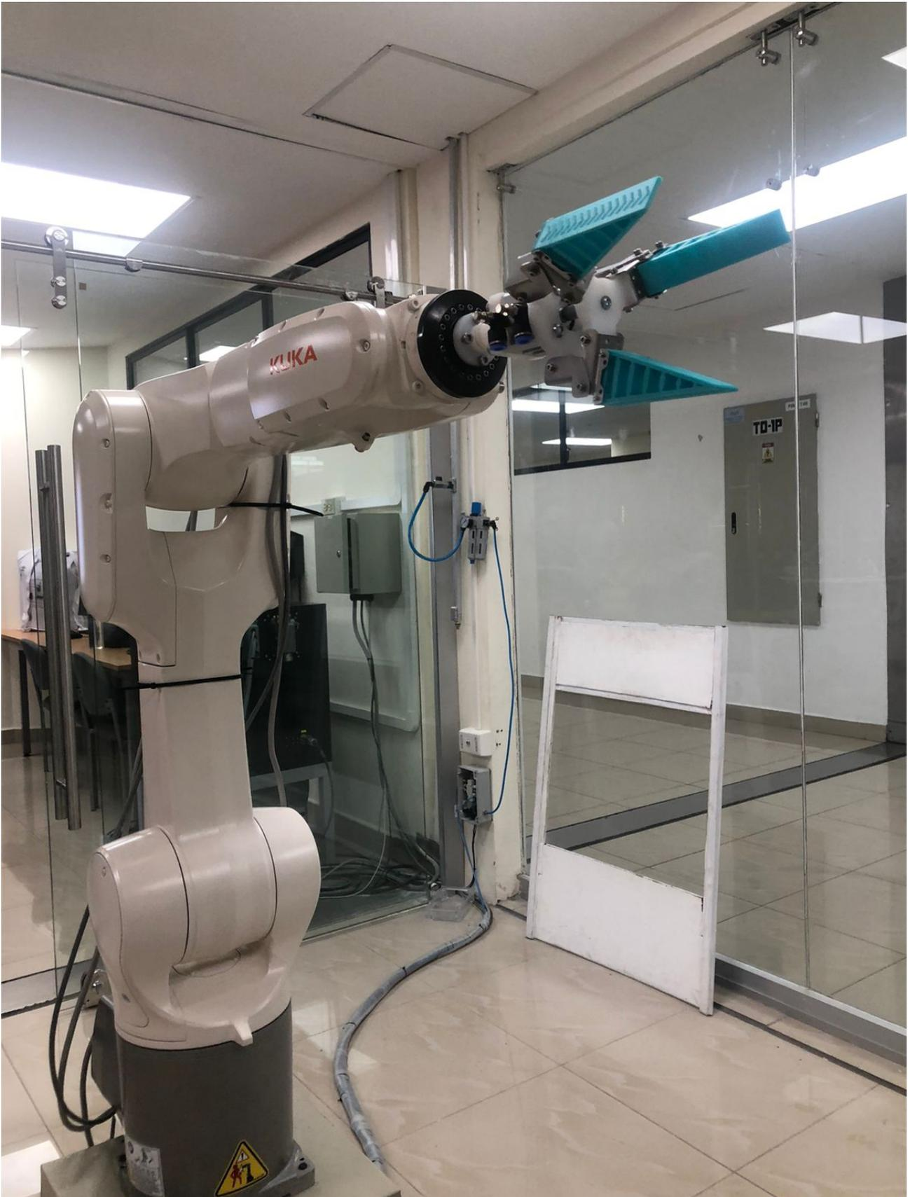
Figura 46. Montaje de gripper con la base fabricada, por D. Córdova.
