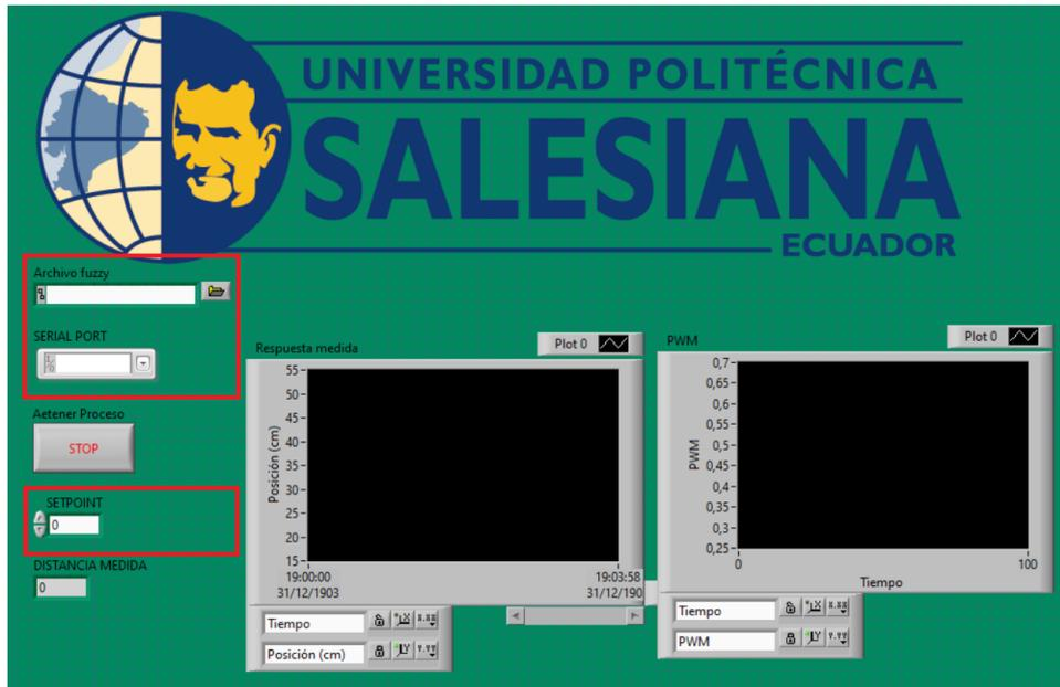
Figura 99: Configuración Inicial de la Práctica: Especificación del Puerto Arduino, Ruta del Archivo “.fs” y “Setpoint”.
