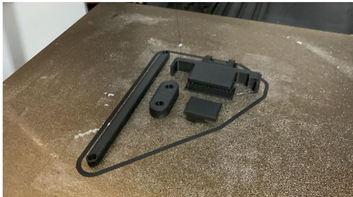
(b) Acople viga con biela
