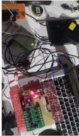
Figura 37. Prueba de los diferentes nodos en el tablero baquerita. Fuente: Los Autores
