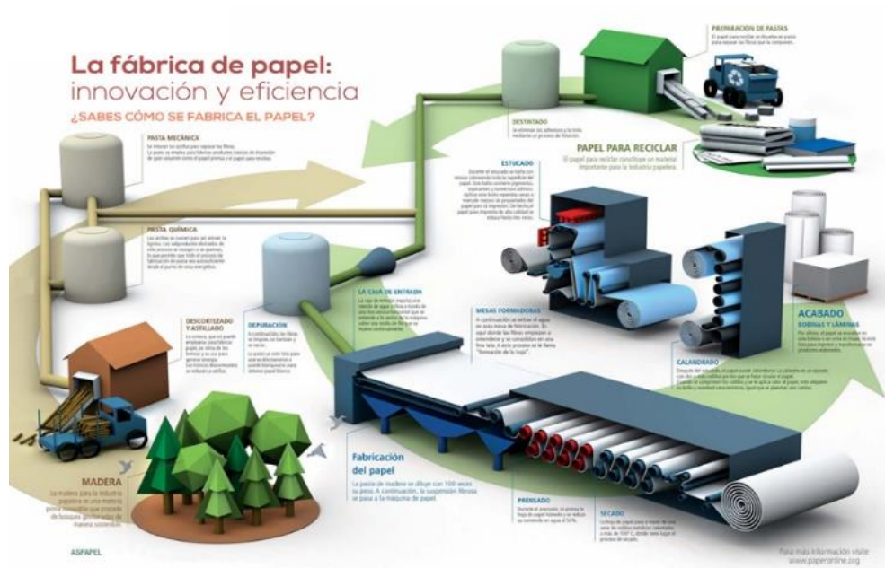
Figura 1: Proceso de la fabricación de papel. (ASpapel, n.d.)
