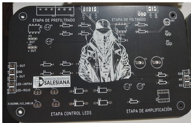
Figura 29: Tarjeta Interfaz con el Sensor de Oximetría (terminada)
