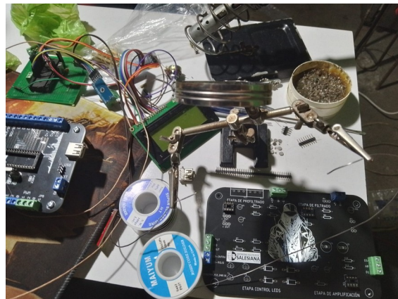
Figura 31: Proceso de soldadura para la Tarjeta Interfaz con el Sensor de Oximetría
