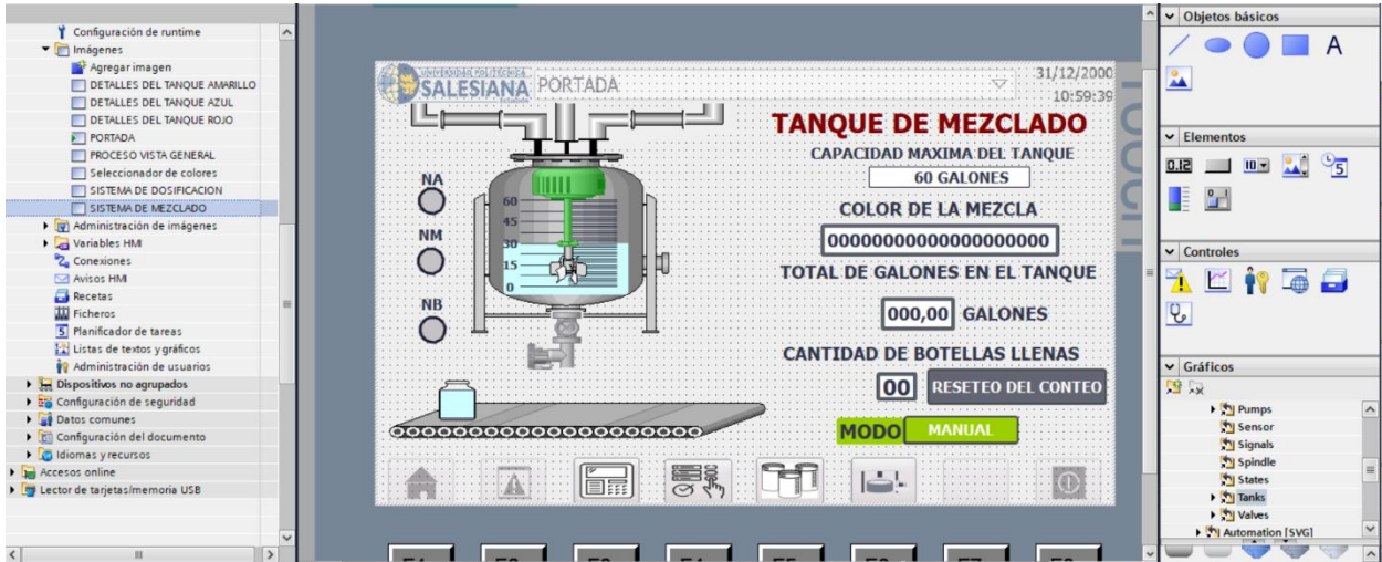
Figura 62. Diseño del tanque de mezcla
