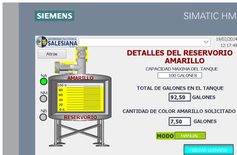
Figura 81. Ejecución del llenado de tanque de modo manual
