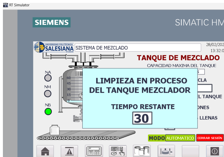
Figura 79. Ejecución de limpieza del tanque mezclador
