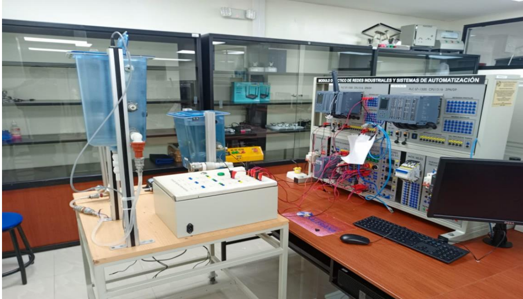
Figura 29. Implementación del módulo de llenado de tanques
