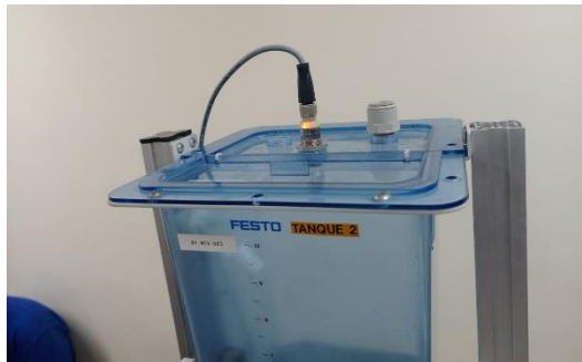
Figura 33. Calibración del sensor ultrasónico
