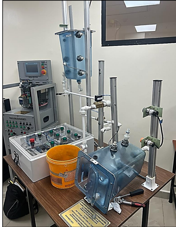
Fig. 18.- Desinstalación de Sensores Capacitivos y de Tipo Boya
