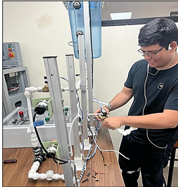
Fig. 20.- Desmontaje de Válvula Solenoide
