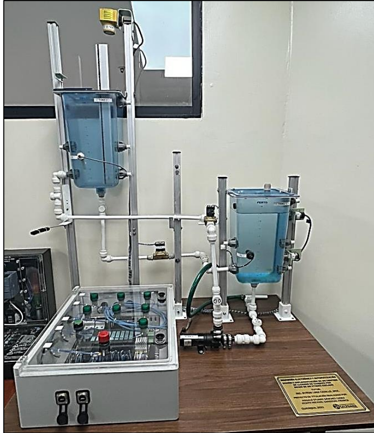
Fig. 4.- Planta De Llenado De Tanques
