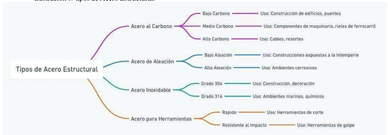
Ilustración 9/ tipos de Acero Estructural.
