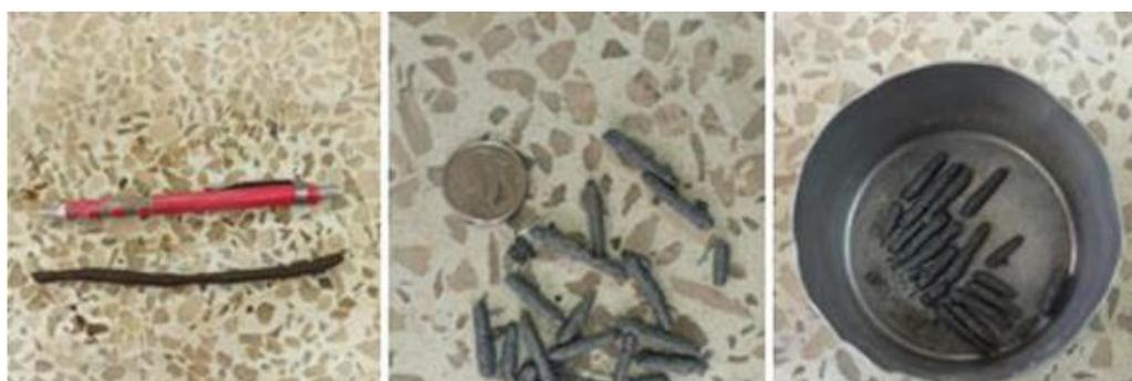
**Figura 4.15:** Ensayo limite plástico.
