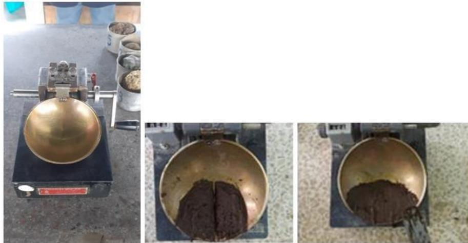
**Figura 4.13:** Ensayo de limite líquido.
