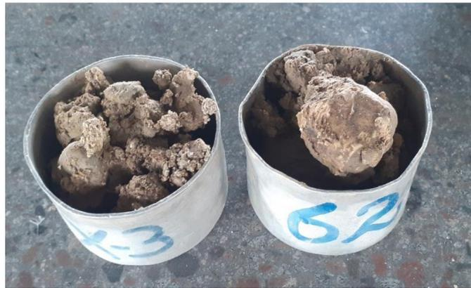
**Figura 4.11:** Muestra luego de 24h en el horno para realizar el tamizado.
