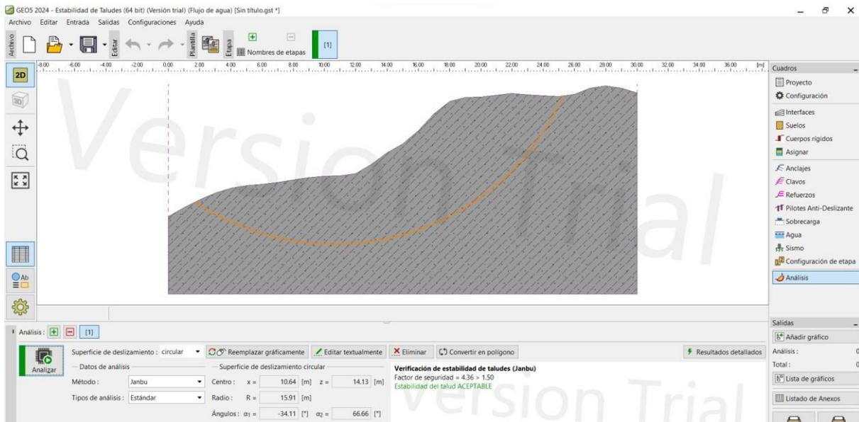
Figura 4.25: Análisis de estabilidad de taludes (METODO DE JANBU).
