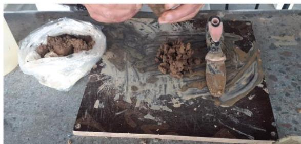
**Figura 4.10:** Ensayo de clasificación de suelos.
