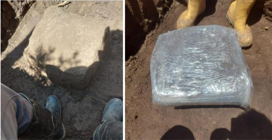
**Figura 4.4:** Bloque 35X35 inalterado para realización del estudio de suelos.
