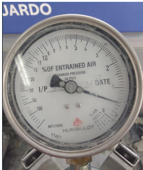
Imagen 24. Toma de Contenido de Aire en planta
