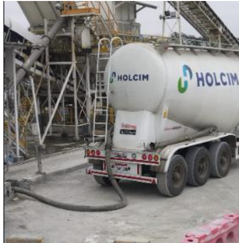
Imagen 11. Cisterna 3 estacionada para descarga de Cemento HE.
