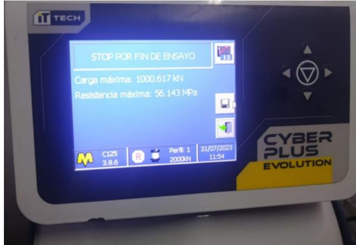
Imagen 51. Lectura de prensa del cilindro de hormigón de 420 kg/cm 2 a 28 días de la toma de muestra.
