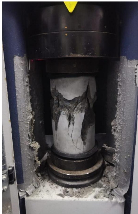
Imagen 52. Cilindro de alta resistencia Hormigón de 420 kg/cm 2 a los 3 días realizando seguimiento al diseño se rompió a los 28 días de la roma de muestra.
