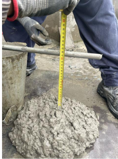
Imagen 2. Revenimiento de hormigón 350 Kg/cm 2
