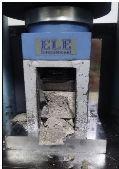
Imagen 14. Muestra de mortero de Cemento HE roto en prensa
