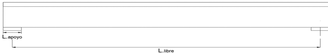
Ilustración 15. Vista lateral de viga doble T.
