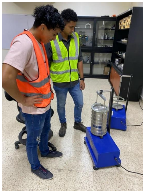
Ilustración 27 Utilización de maquina tamizadora para ensayo granulométrico de los especímenes de las calicatas
