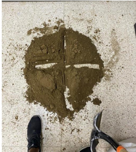
Ilustración 24 Aplicación del ensayo de muestreo de los agregados para ensayos de la calicata 1
