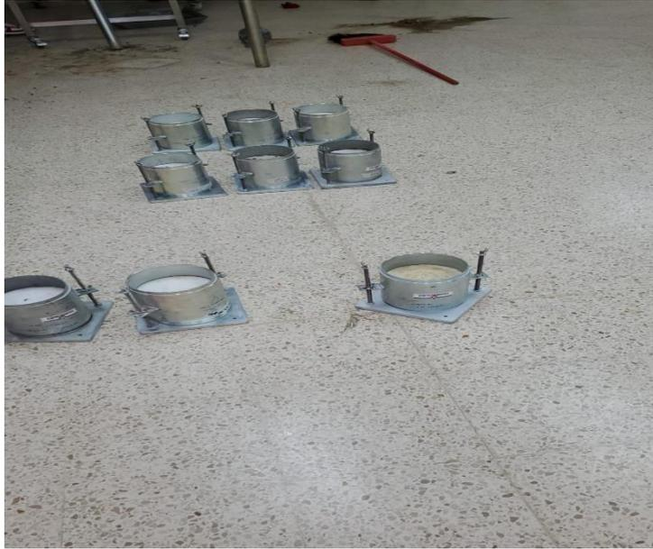
*Ilustración 117 Ensayo CBR para colocación de cargas*
