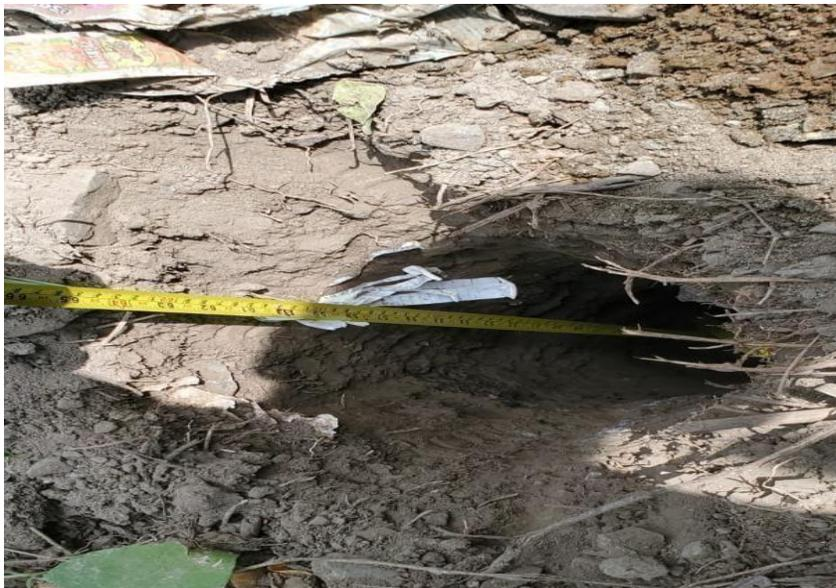
*Ilustración 86 Medición de profundidad de 1.50 metros calicata 1*
