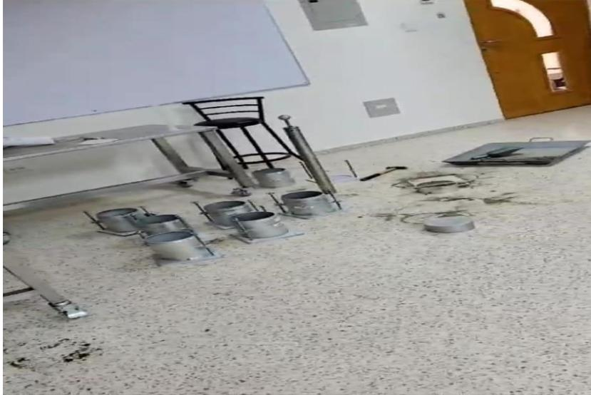
*Ilustración 115 Ensayo de CBR de las 3 calicatas*
