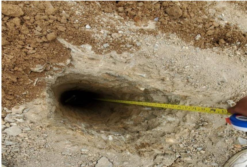
*Ilustración 90 Medición de 1.50 metros calicata 3*
