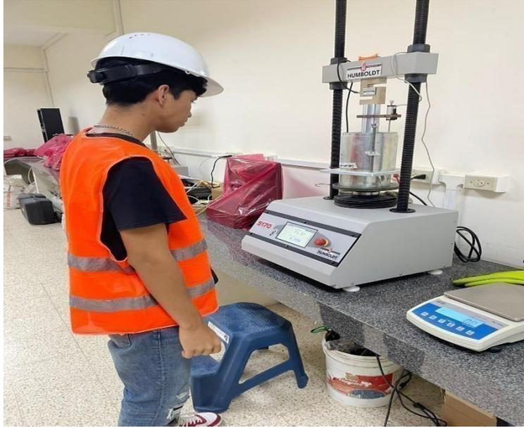
*Ilustración 119 Toma de datos del ensayo CBR*
