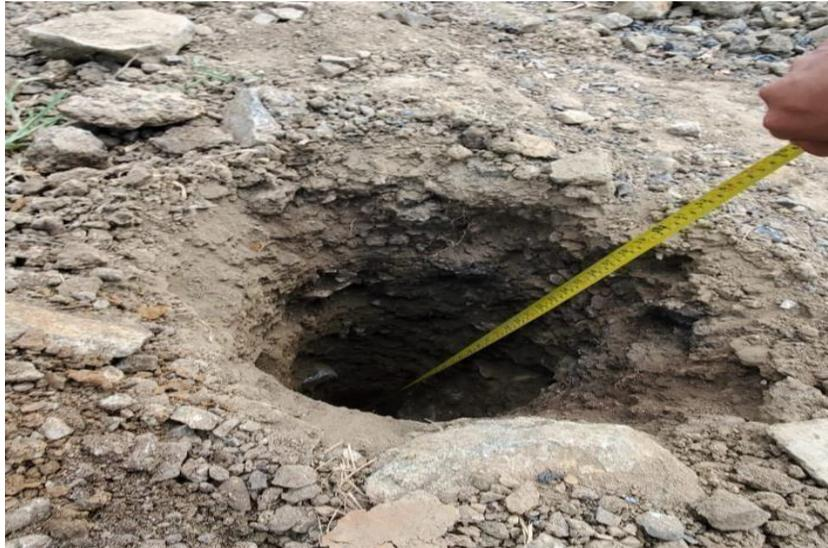
*Ilustración 87 Medición de profundidad de 1.50 metros calicata 2*
