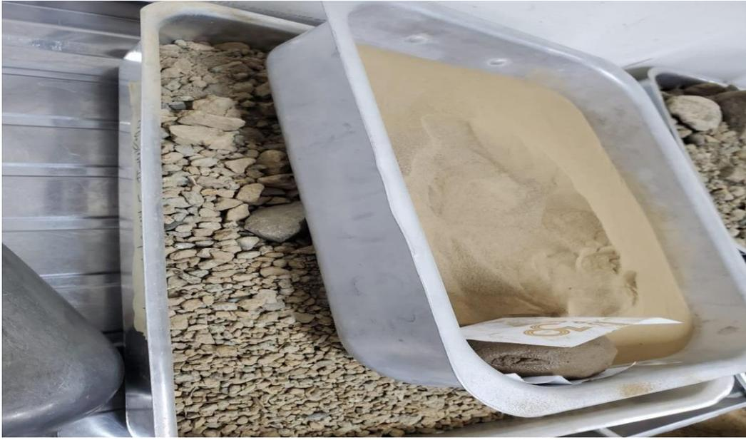
*Ilustración 101 Separación del tamizado grava y fino calicata 3*
