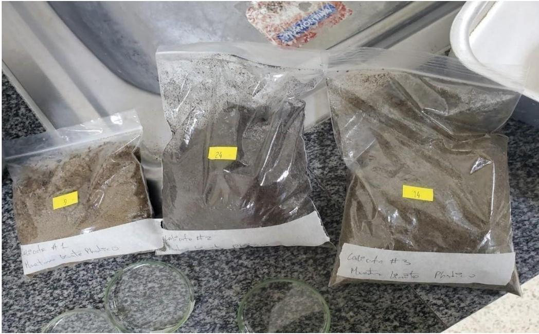
*Ilustración 107 Muestra de humedad natural de las 3 calicatas*
