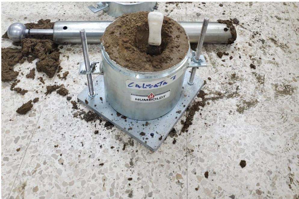
*Ilustración 112 Ensayo Proctor calicata 3*
