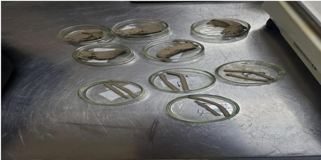
*Ilustración 104 Ensayo de límite líquido y plástico calicata 1*
