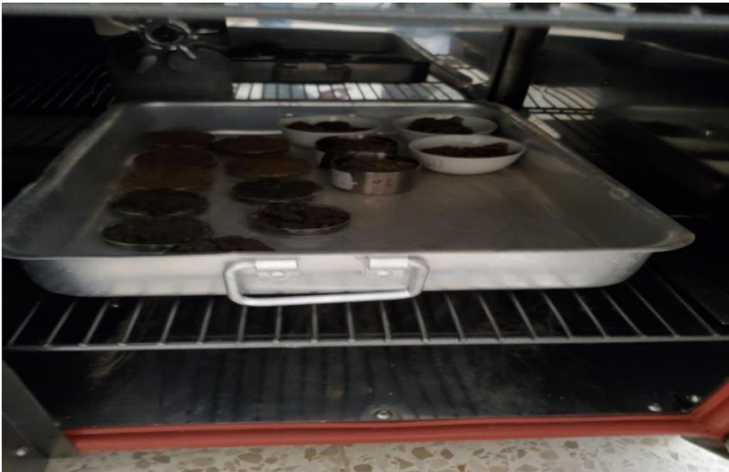
*Ilustración 114 Muestras de las 3 calicatas al horno*
