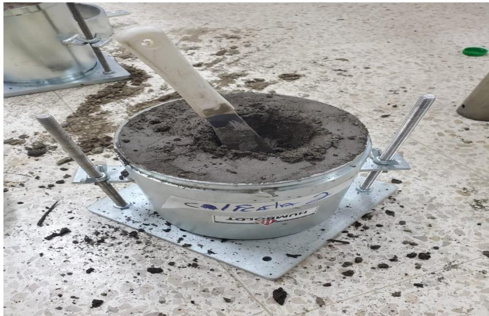
*Ilustración 110 Ensayo Proctor calicata 2*
