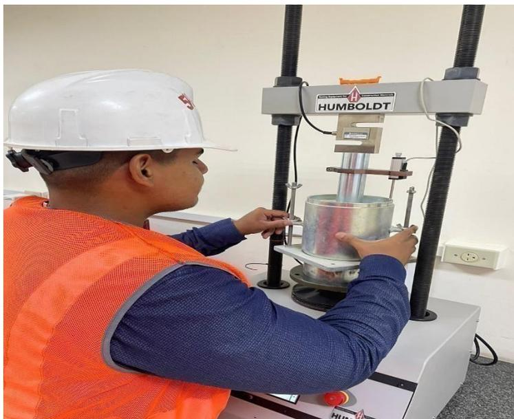
*Ilustración 118 Colocación del cilindro en la maquina CBR*
