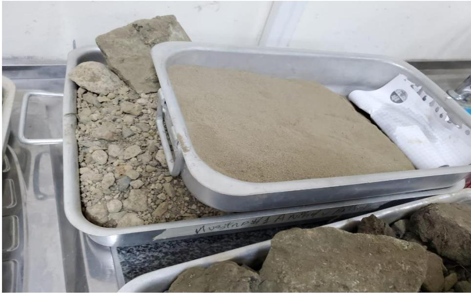
*Ilustración 99 Separación del tamizado grava y fino calicata 1*
