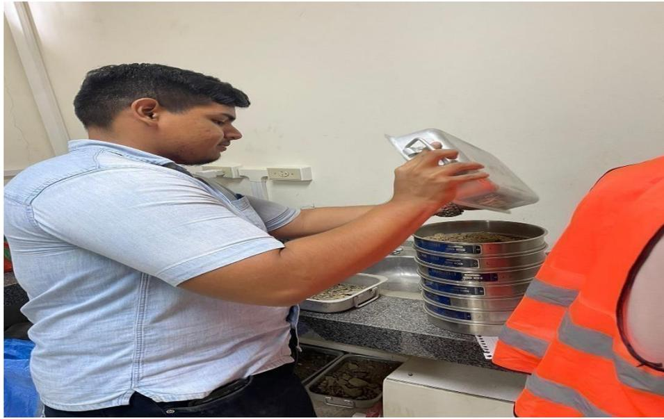
*Ilustración 95 tamizado de la muestra*
