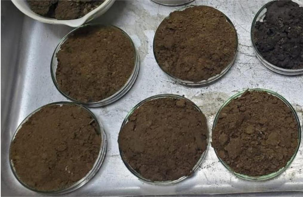
*Ilustración 113 Muestra del ensayo Proctor calicata 3*
