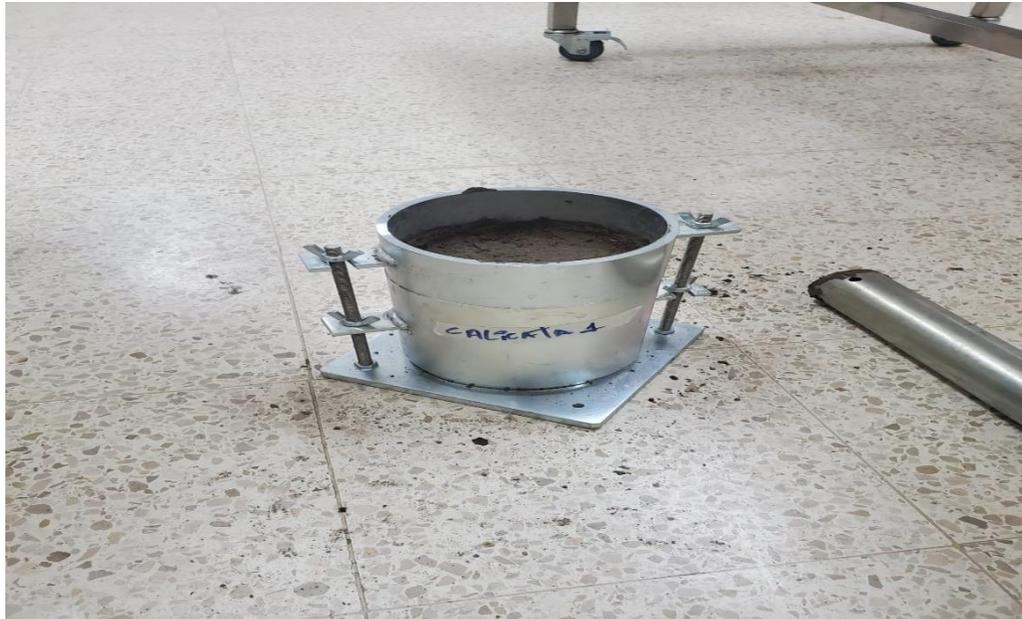
*Ilustración 108 Ensayo Proctor calicata 1*
