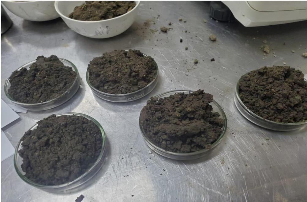
*Ilustración 111 Muestra del ensayo Proctor calicata 2*
