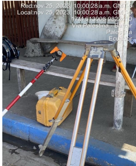
Ilustración 33.- Equipos para la topografía con estación total
