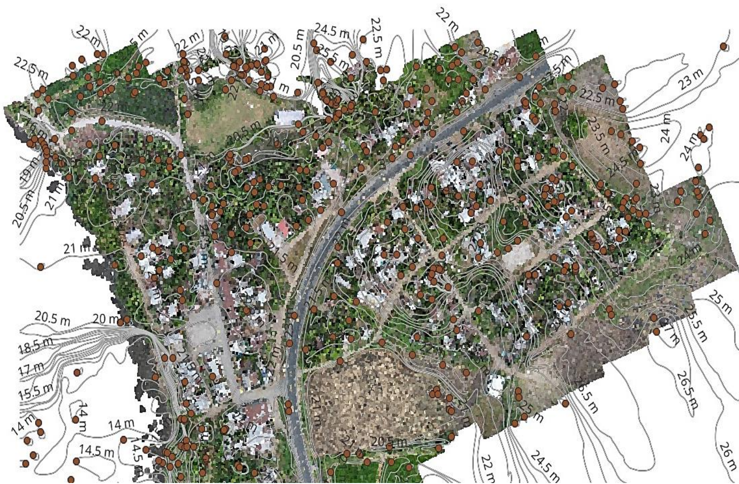
Ilustración 4.- Topografía del terreno con curvas de nivel en QGIS
