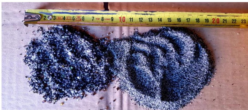
Figura 6. Diferencias entre granalla y arena.
