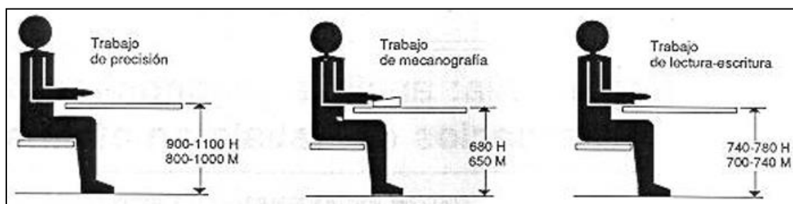
Figura 2. Altura del plano de trabajo para puestos de trabajo sentado (cotas en mm).
