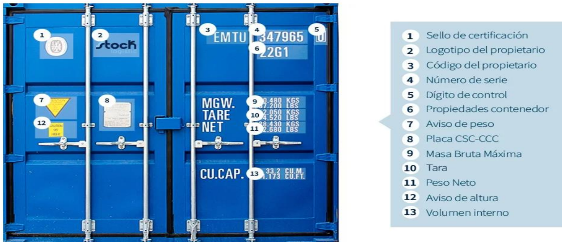
Figura 2.6 Códigos de un contenedor Marítimo
