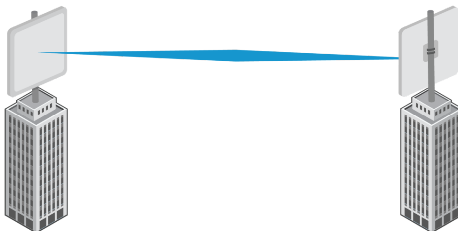
Figura 1.1: Topología de una red Punto a punto.
