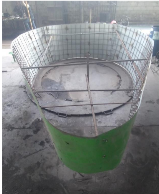
Figura 3.6: Refuerzo del molde
