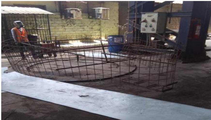
Figura 3.4: Soporte del molde
