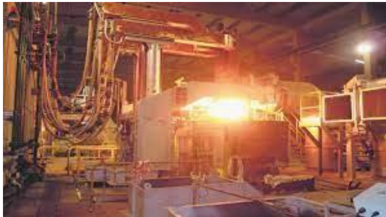
Figura 2.18: Horno arco eléctrico
