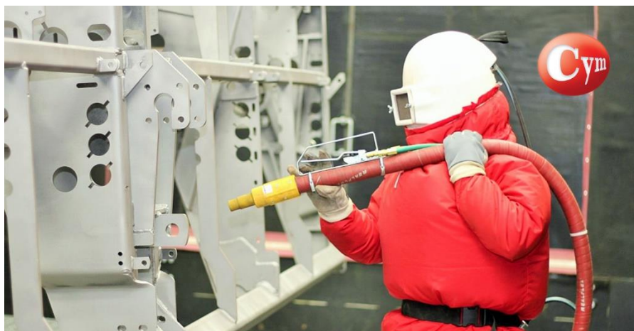
Figura 2.5 Proceso de granallado por aire comprimido
