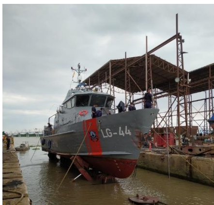
Figura 2.8 Proceso Pre-granallado en el barco LG-44 en ASTINAVE. S.P.
