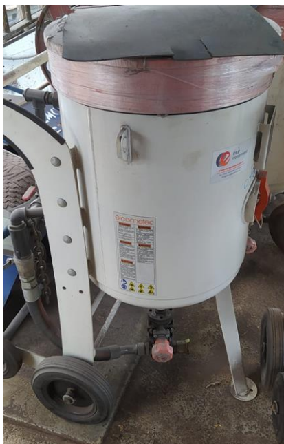
Figura 2.11 Maquinaria de chorro abrasivo portátil Elcometer 200C - Grupo Testek
