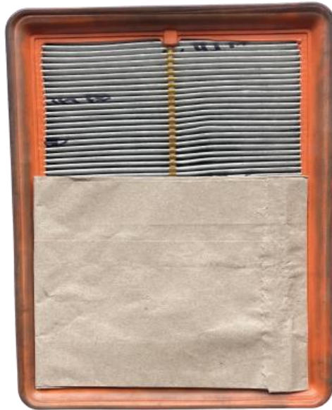
Figura 24 Filtro de aire tapado al 50 %.
