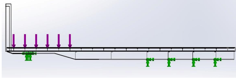
Figura 33. Carga distribuida en escenario 1
