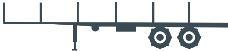
Figura 6. Semirremolque plataforma plana postes [15]
