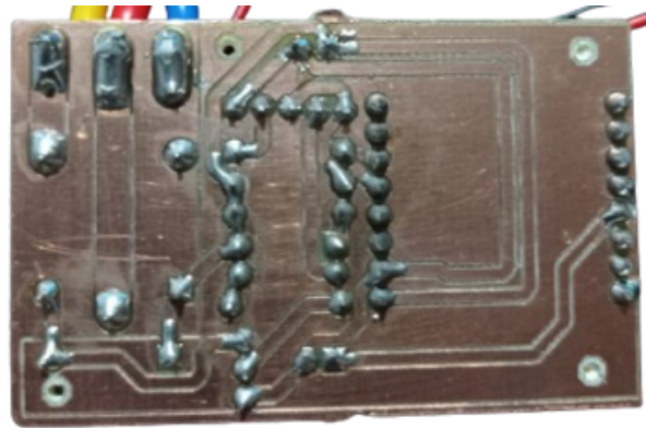
Figura 2.12: Soldadura de componentes en placa.
