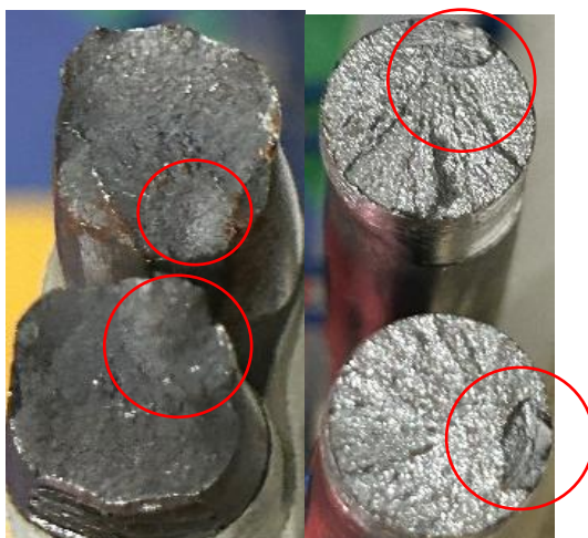
Figura 27. Análisis de falla probetas 4 y 5 sin post calentamiento
