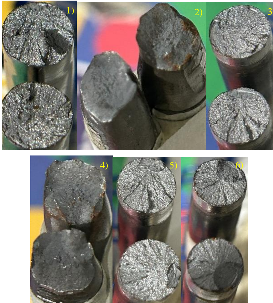
Figura 20. Caras de rotura de probetas sin post calentamiento.
