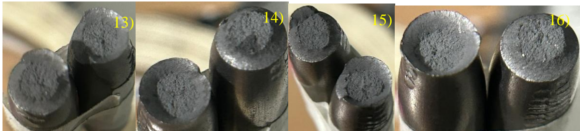
Figura 24. Caras de rotura de probetas de suministro.
