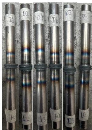
Figura 14. Probetas sin post calentamiento soldadas a fricción
