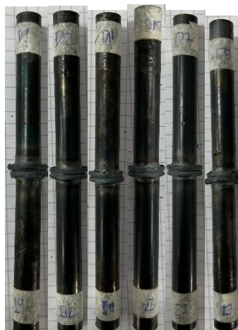
Figura 16. Probetas sin post calentamiento soldadas a fricción
