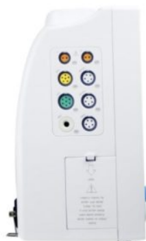
Figura 4-3: Vista Lateral del Monitor-Módulos de Medición
