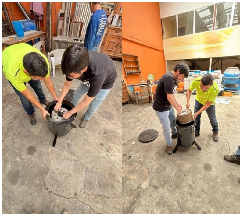
Figura 24. - Introducción de los filtros con tierra filtrante en el contenedor
