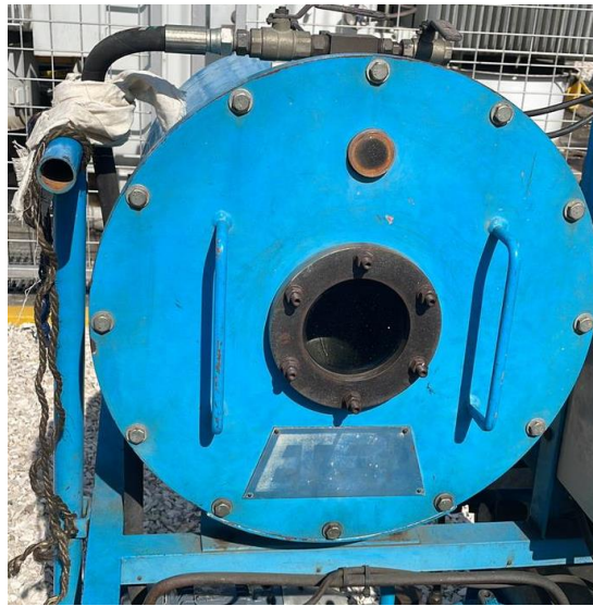
Figura 15.- Cámara de termovació
